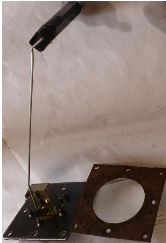
Figura 3.7 Transductor potenciométrico utilizado para medir el nivel de diesel (Sensor de nivel de flotador + potenciómetro)
