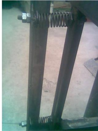
**Figura 4.18. Ubicación del sistema de resortes en la estructura**
