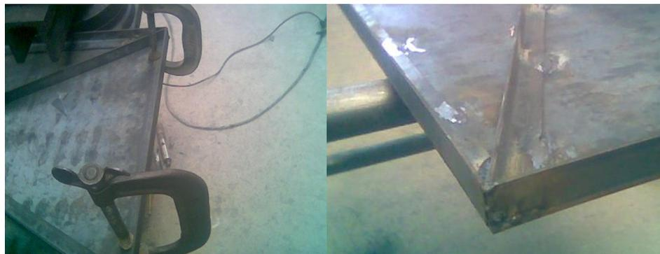
**Figura 4.3. Aseguramiento del marco inferior**
