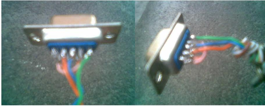
**Figura 4.33. Conexión Null Modem al Pc**
