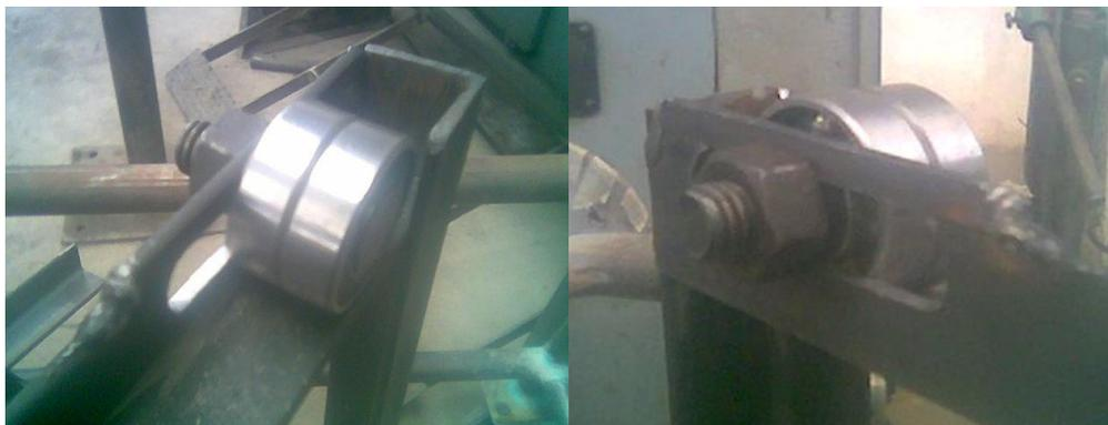
**Figura 4.9. Mecanismo de movimiento perno - rodamiento**
