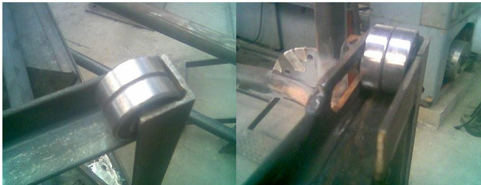
**Figura 4.8. Prueba de holgura en el riel de la estructura**
