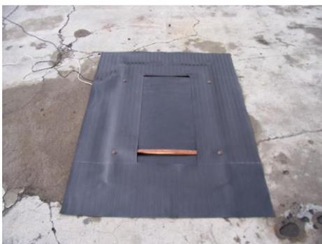
**Figura 5.1. Ubicación de la placa de medición**
