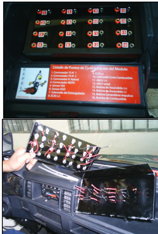
Figura 4.16. Instalación de los puntos de comprobación.
