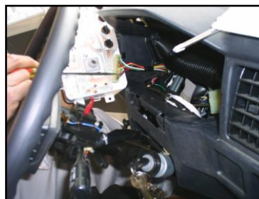
Figura 2.27. Desinstalación del sensor de velocidad.
