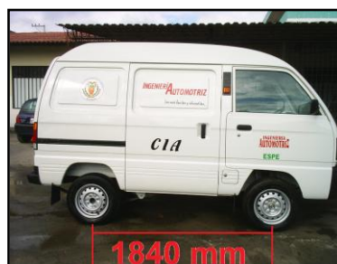
Figura 1.5. Distancia entre ejes: 1.840 mm.
