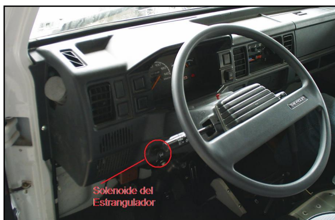
Figura 2.38. Desinstalación del solenoide de estrangulación.
