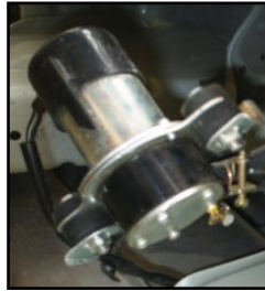
Figura 2.44. Desinstalación de la bomba de combustible.
