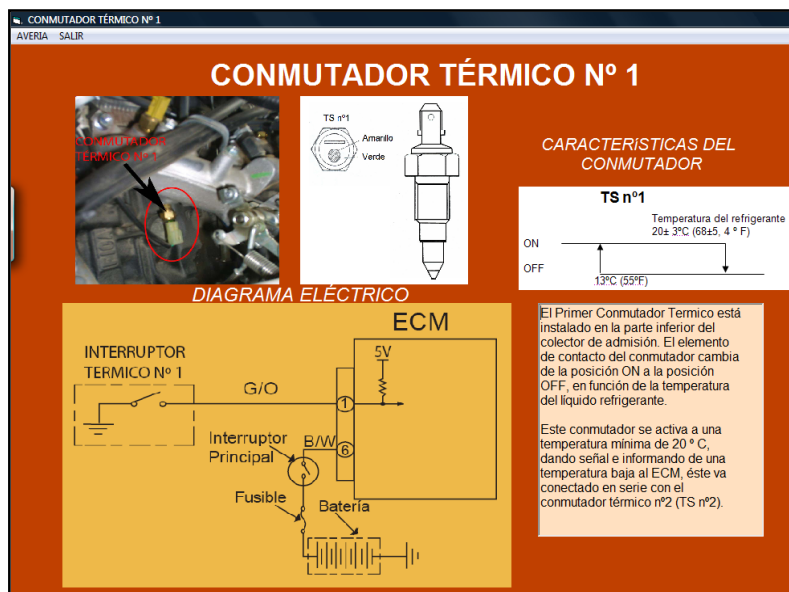
Figura 4.31. Diagrama eléctrico y funcionamiento del conmutador térmico # 1.
