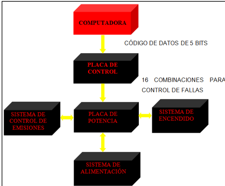
Figura 3.23. Diagrama de bloques de señales de entradas / salidas del sistema de entrenamiento del vehículo chevrolet super carry 1L.
