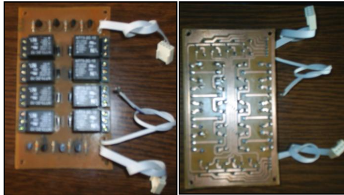
Figura 3.47. Placa de control de potencia terminada.
