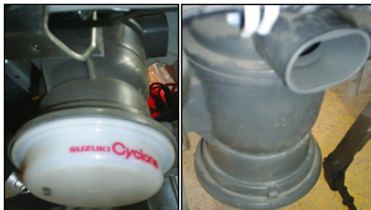
Figura 1.43. Ubicación del depurador alternativo de aire.
