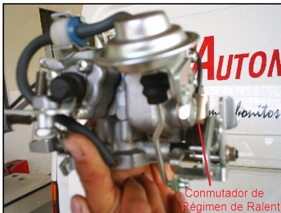
Figura 2.12. Desinstalación del conmutador de régimen de ralentí.
