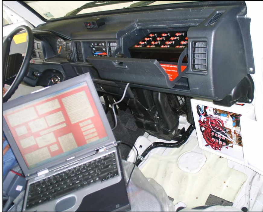
Figura 4.18 Simulación de falla con el módulo de entrenamiento.
