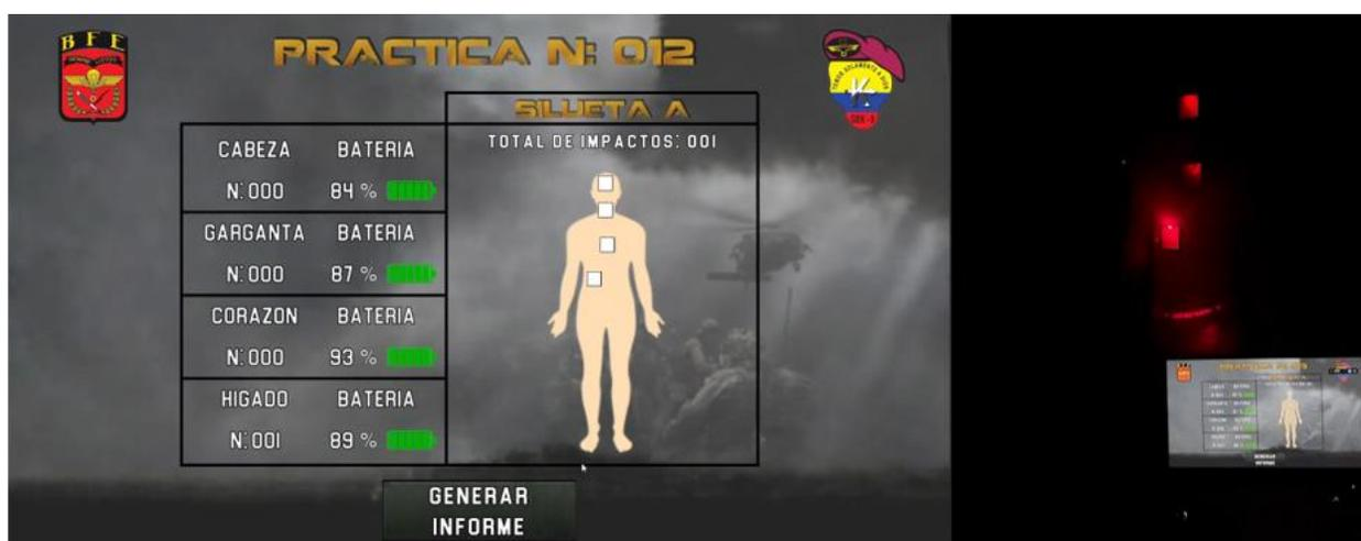
*Nota.* La figura muestra el porcentaje de batería del nodo sensor y el disparo efectuado.
