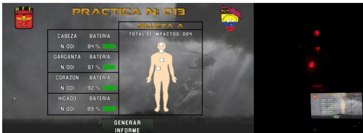
*Nota.* La figura muestra el número de impactos distribuidos entre los 4 puntos letales. Además, se muestra la sincronización existente entre el impacto recibido en el sistema físico y la animación del HMI para muestra del impacto receptado.
