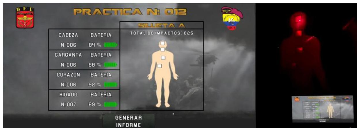
*Nota.* La figura muestra el porcentaje de batería de cada nodo sensor y la cuantificación de los impactos realizados en cada punto letal sobre la silueta.
