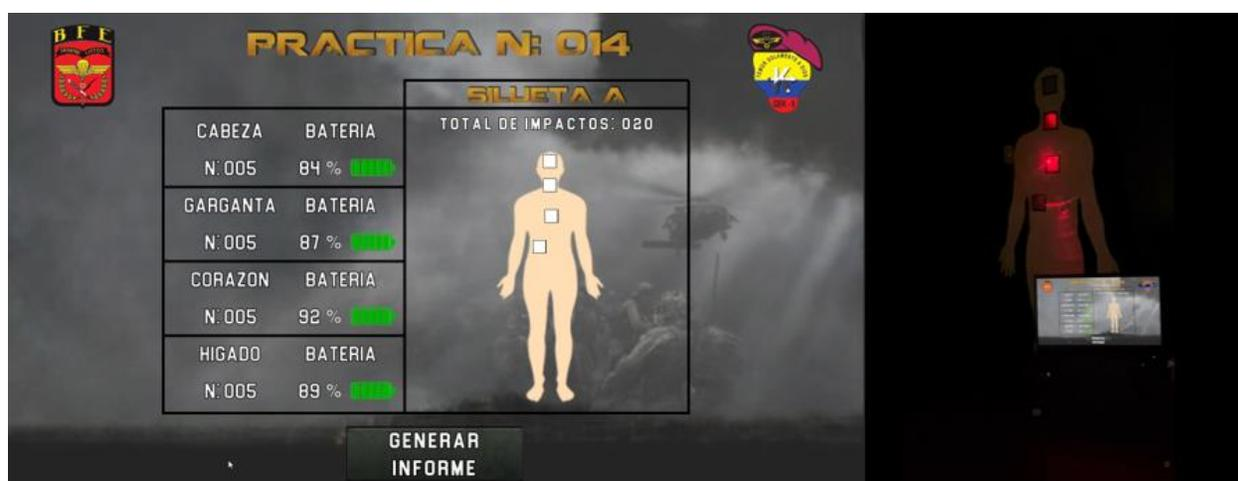
*Nota.* La figura muestra la prueba de funcionamiento 4 con un total de 20 impactos detectados.
