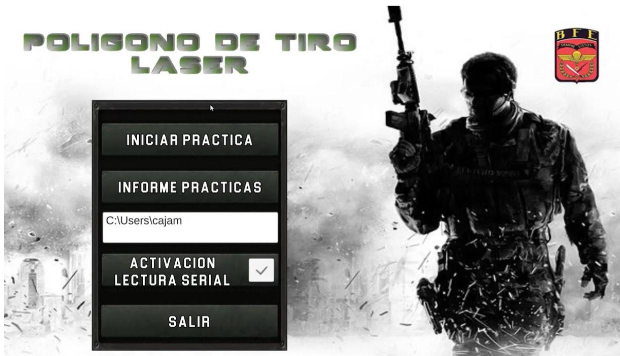
*Nota.* La figura muestra la activación de lectura serial y dirección de la base de datos ingresada en el HMI de Unity3D.
