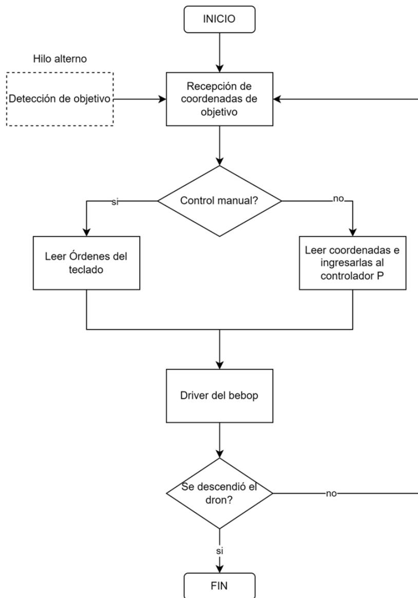
En la implementación del código en Python, la clase recibe los siguientes parámetros: El objeto Bebop creado con pyparrot, el setpoint que debe seguir el objeto detectado (se ubica por defecto en el centro de la cámara) y la velocidad máxima que se desea que se alcance cuando se ejecuta el control.
