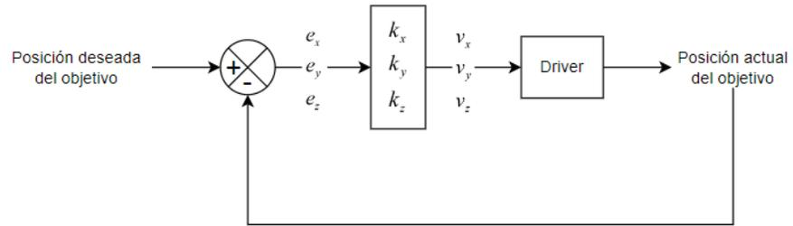
El algoritmo para el control de posición del VANT se presenta en el siguiente diagrama de flujo:
