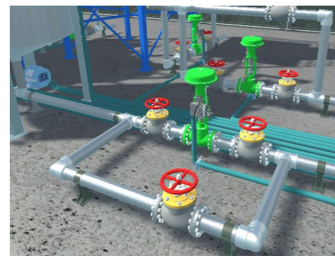
Válvulas de control
