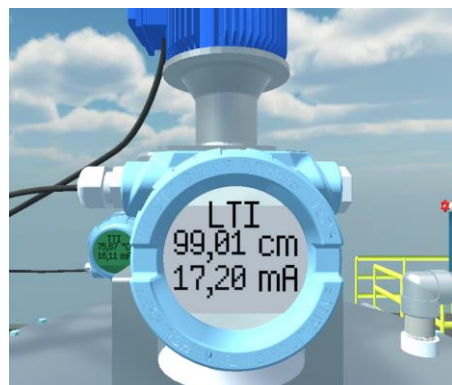
Transmisor de nivel (5408 radar)
