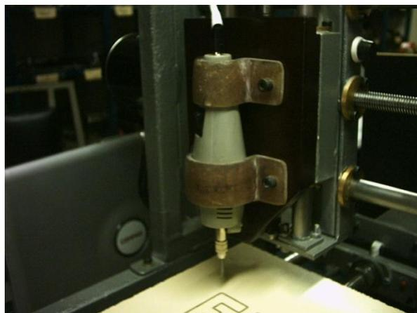
**Figura 4.15** Base soporte para el motor cabezal taladrador
