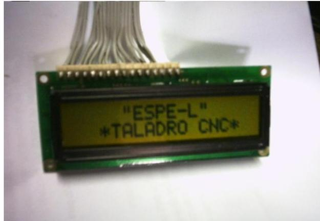
**Figura 4.19** Conexionado desde el PIC al LCD
