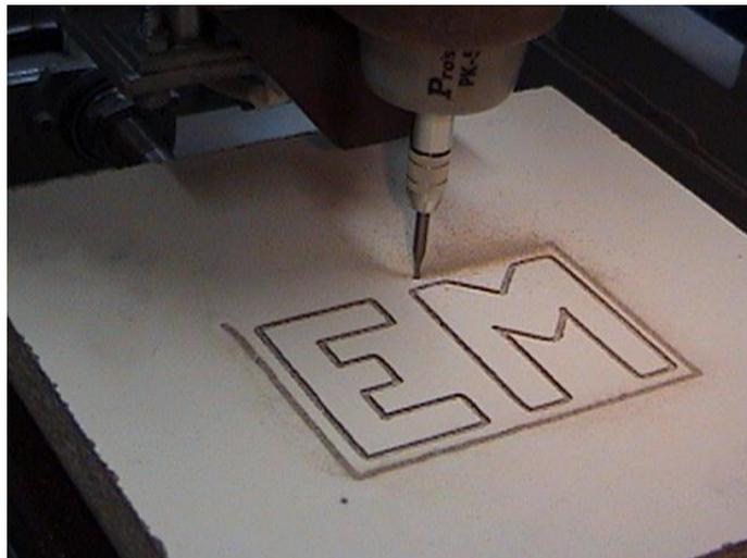
Figura1.1 Taladradora CNC ("control numérico computarizado").
