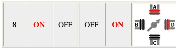
**Figura 3.21** Secuencia Tipo Medio Paso de Funcionamiento para Unipolares
