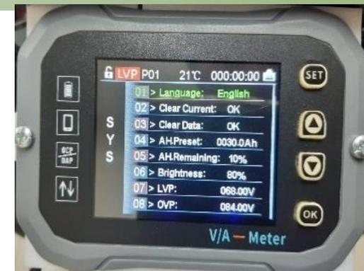
Calibrar el medidor a 22Ah
