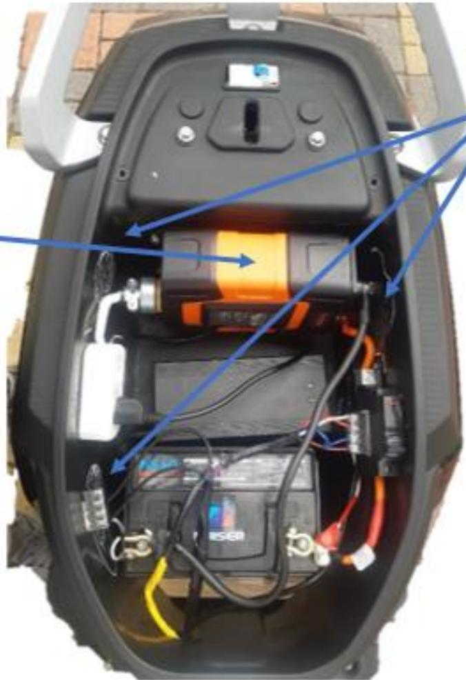
Orificios de ventilación ubicado en la maleta para una mejor disipación del calor
