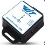
Incorporar un sistema de monitoreo de los sistemas de suspensión evaluando aceleraciones, velocidades angulares, grados de inclinación en los tres ejes de coordenadas
