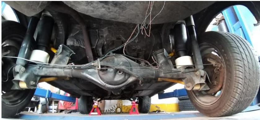
*Nota.* En la figura se muestra el resultado final de la implementación de los muelles neumáticos en el eje posterior.
