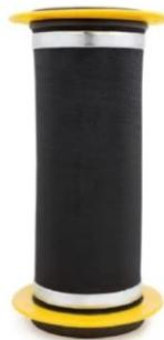
*Nota.* En la figura se muestra la representación del muelle neumático utilizado en el eje delantero. Recuperado de (Tebao, 2023)
