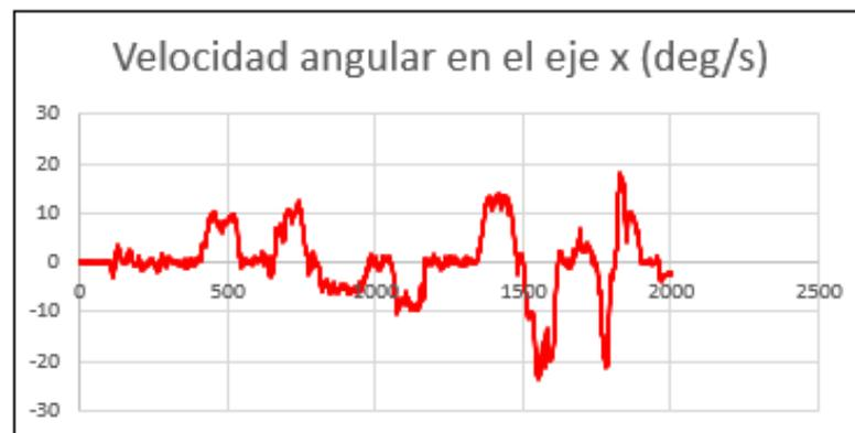
Nota. En la gráfica se muestra el comportamiento del vehículo respecto a las velocidades angulares en la condición de curva derecha e izquierda.
