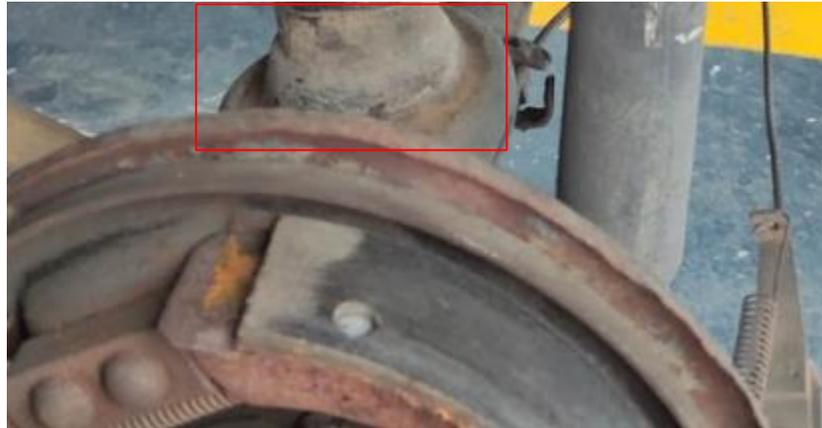
*Nota.* En la figura se muestra la geometría de las bases del muelle helicoidal de acero.
