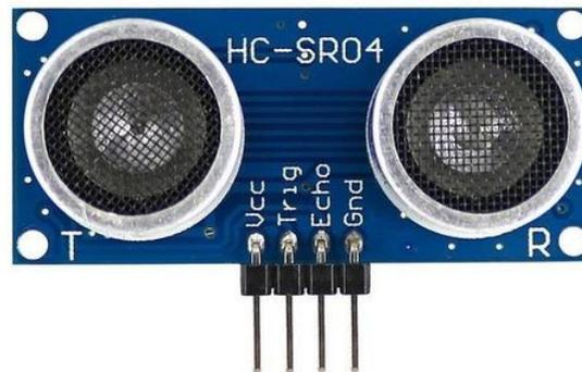
*Nota.* En la figura se muestra la representación de un sensor ultrasónico compatible con Arduino.
