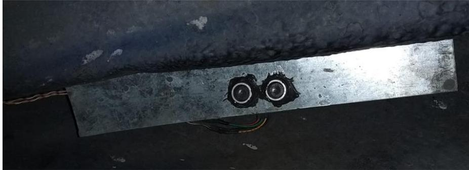
*Nota.* En la figura se muestra los sensores ultrasónicos implementados en los cuatro puntos del vehículo.
