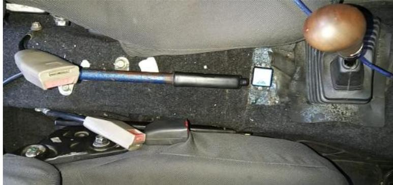
*Nota.* En la figura se muestra la ubicación del inclinómetro en el centro de gravedad del vehículo con la consideración de la posición de los ejes.
