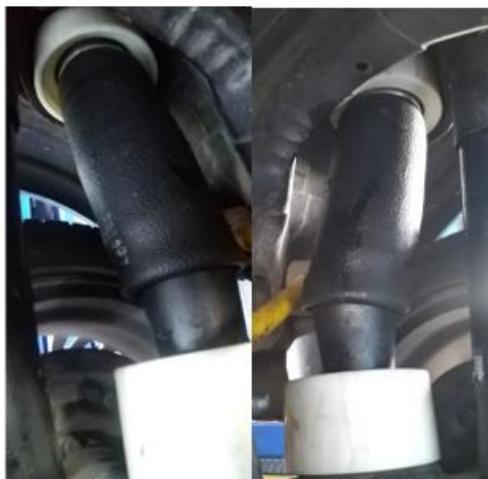
*Nota.* En la figura se muestra los soportes de los muelles neumáticos en el eje posterior.
