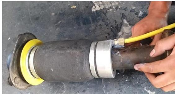
*Nota.* En la figura se muestra la conexión neumática en el muelle
