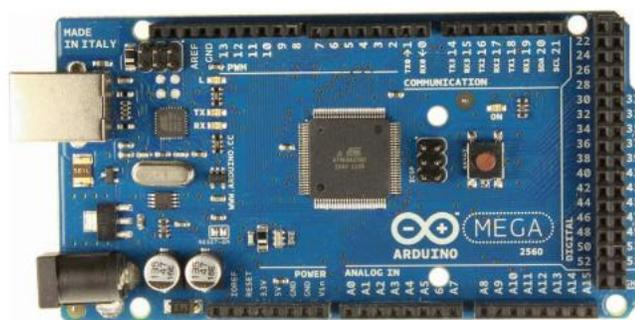
*Nota.* En la figura se muestra la representación del Arduino Mega.
