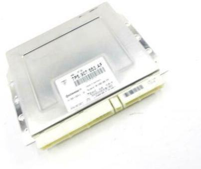
*Nota.* La figura representa la unidad de control del sistema de suspensión neumática el cual tiene la función de controlar el circuito eléctrico y electrónico del sistema. Recuperado de (Viking, 2023).
