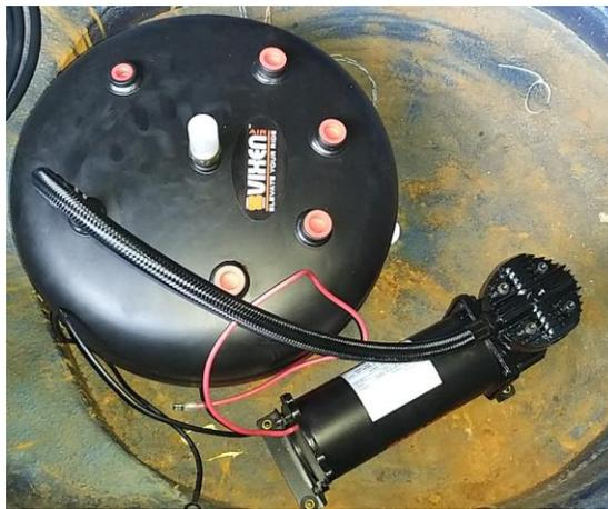
*Nota.* En la figura se muestra la ubicación real del compresor y tanque de reserva del sistema de suspensión neumático.
