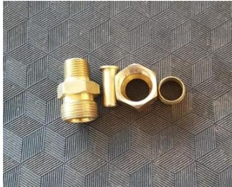
*Nota.* En la figura se muestra los acoples utilizados en la conexión de las mangueras neumáticas.
