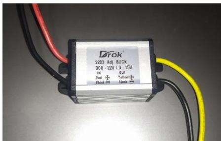
*Nota.* La coloración del cableado indica la entrada y la salida del voltaje.
