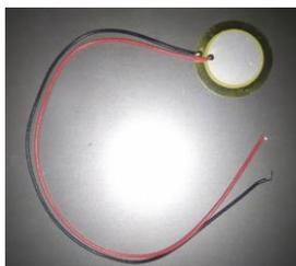
*Nota.* El sensor tiene una soldadura de sus terminales positivo y negativo.
