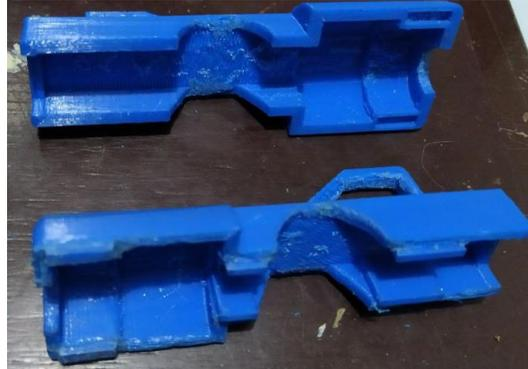
*Nota.* Las partes impresas necesitan un terminado manual en donde se retiran las imperfecciones.
