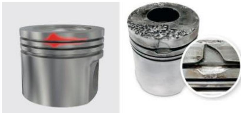
*Nota.* El desgaste del pistón en el área de los rines se debe a una cantidad excesiva de combustible. Tomado de (Rheinmetal, 2018).
