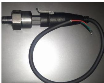
*Nota.* Transductor apto para medir presiones de diesel y gasolina.
