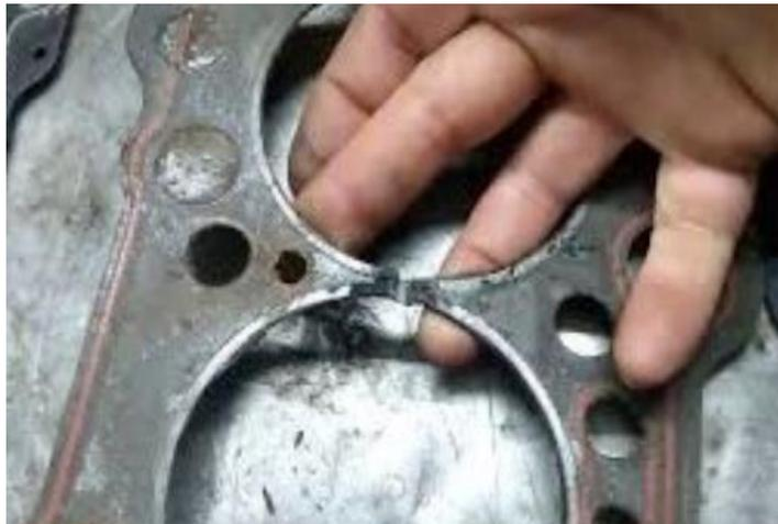
*Nota.* Cuando existe una fisura del empaque entre anillos, la compresión de ambos cilindros disminuye y la comparten. Tomado de (Top,2020).
