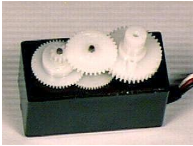
FIGURA No 1.57 Tren de engranajes FIGURA No 1.58 Circuito de realimentación
