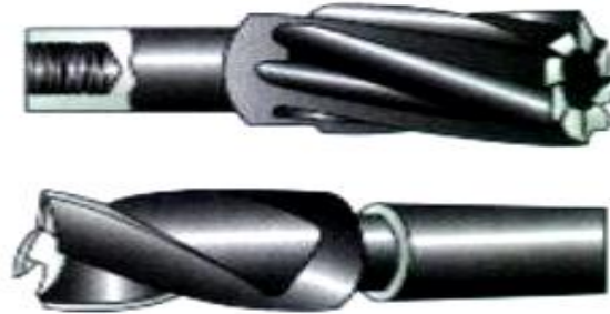
FIGURA No. 1.21 Fresas cilíndrico frontal
