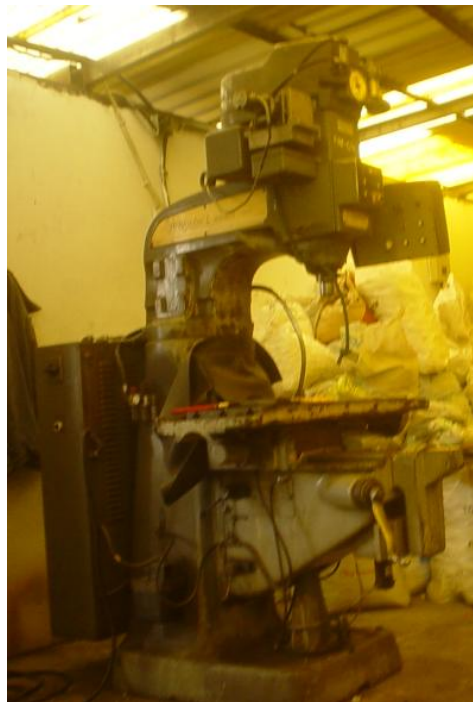
Fresadora Bridgeport antes de Automatización
