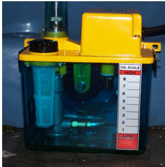
FIGURA No.2.24 Unidad del sistema de lubricación
