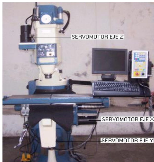
FIGURA No. 4.9 Servomotores instalados en la fresadora
