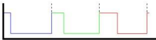
FIGURA No 1.60 PWM de un servo
