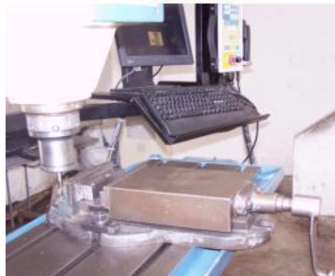
FIGURA No. 4.50 Entenalla instalada en la bancada
