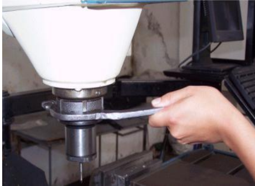
FIGURA No. 4.57 Ajuste de la fresa con la llave de uña
