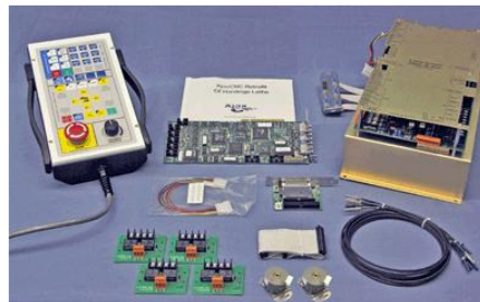
FIGURA No. 4.63 kit de tarjetas fresadora CNC
