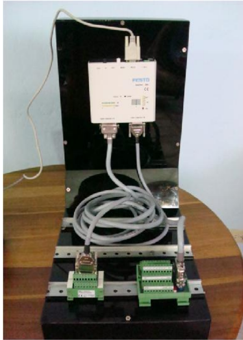
Figura 111. Acople de terminales en los rieles y cables con el módulo Easy Port.
