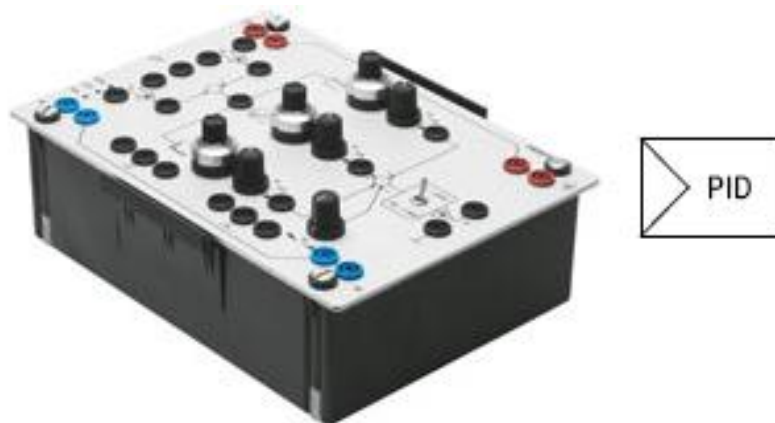
Figura 101. Regulador PID y símbolo
