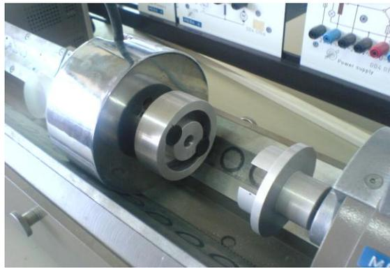
**Figura. 3.15 Encoder acoplado a motor.**
