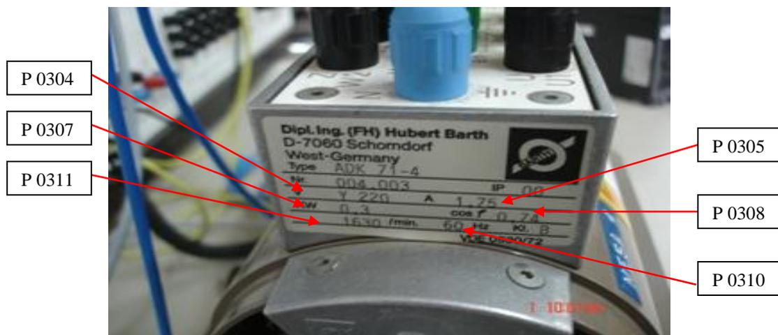
Fig. 3.18 Ajuste de los datos de placa del motor.
