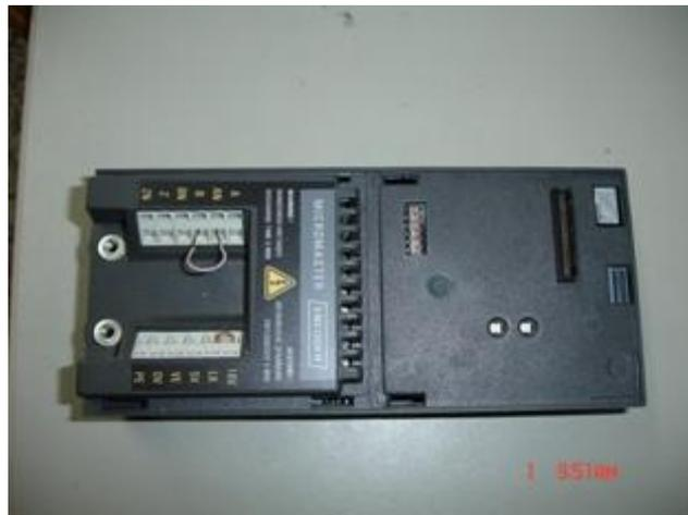
**Figura 3.8 Tarjeta de acoplamiento de encoder.**
