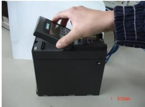
**Fig. 3.10 Colocación de la tarjeta AOP.**
