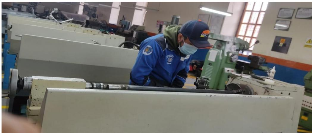
*Nota.* Se muestra el mecanizado del eje.
