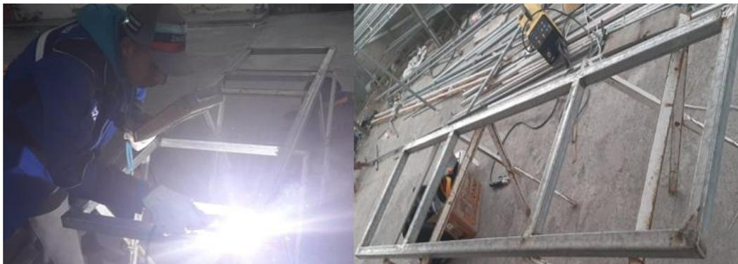
*Nota.* Se observa el proceso de armado y soldado de los tubos.
