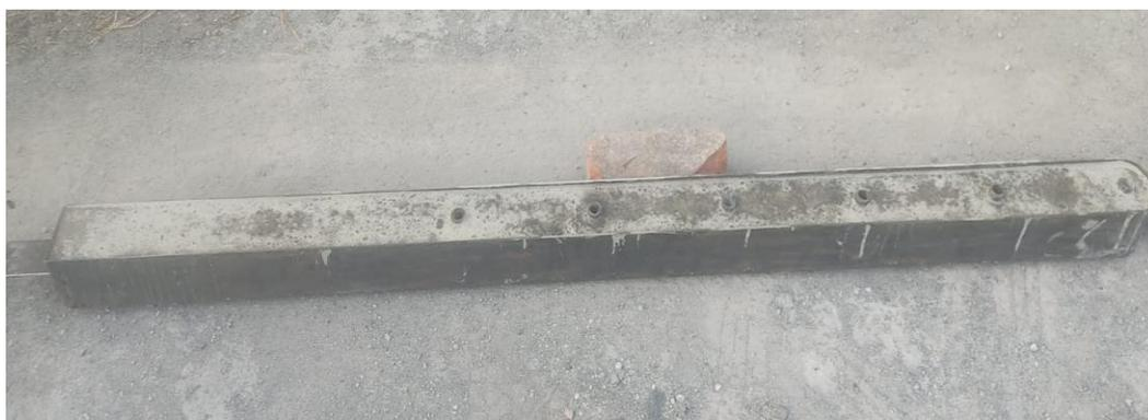
*Nota.* Se muestra el producto dentro del molde con distribución equitativa de mezcla de hormigón y de consistencia compacta.
