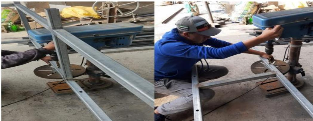
*Nota.* Mecanizado de orificios en el estructura inferior y superior.
