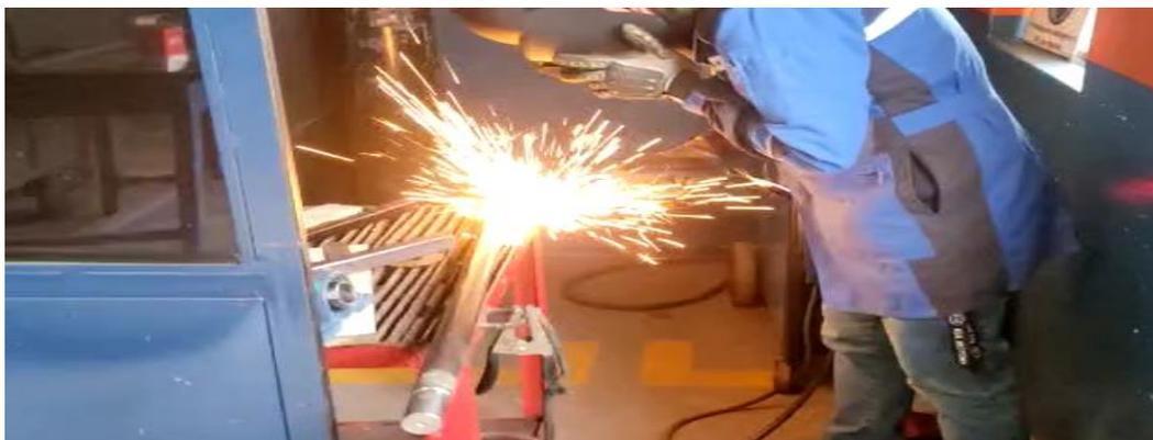
*Nota.* Se muestra la aplicación de soldadura de contorno en el eje.
