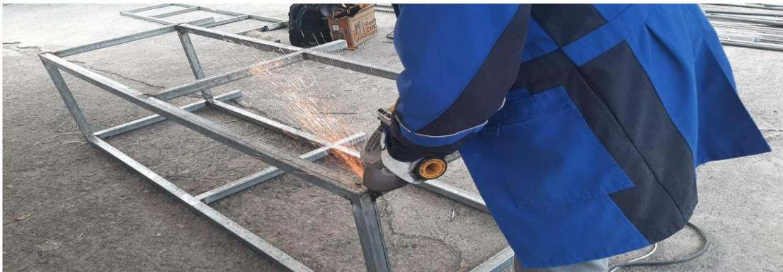
*Nota.* Se muestra el proceso de esmerilado de soldadura.
