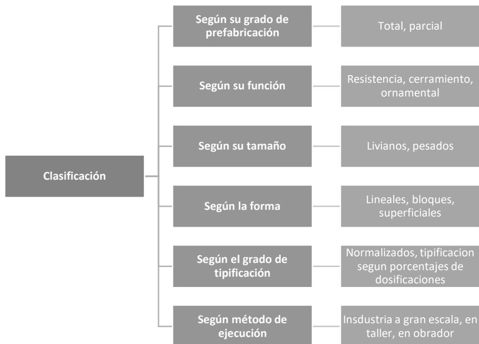
*Nota.* Se indica la principal clasificación de los prefabricados de hormigón. Tomado de (Cueva , 2012).
