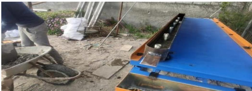
*Nota.* Se muestra la distribución equitativa de la mezcla del hormigón con la máquina en funcionamiento.
