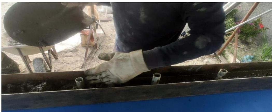
*Nota.* Se muestra el llenado de hormigón en los moldes para pruebas físicas.
