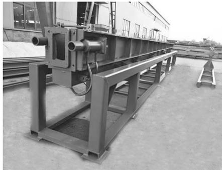
*Nota.* Se muestra un mecanismo de palanca para la evacuación de prefabricado de hormigón.
