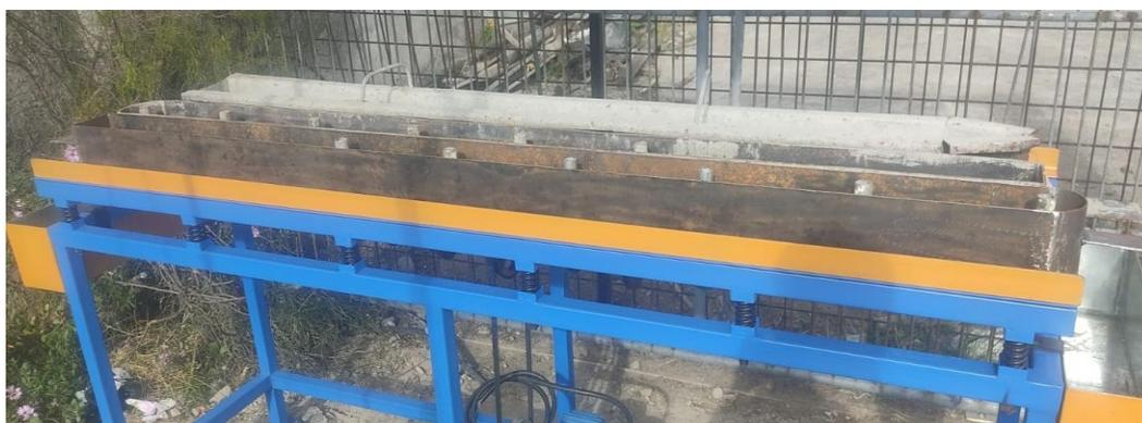
*Nota:* Comprobación de la distribución de los moldes sobre la plataforma vibrante.
