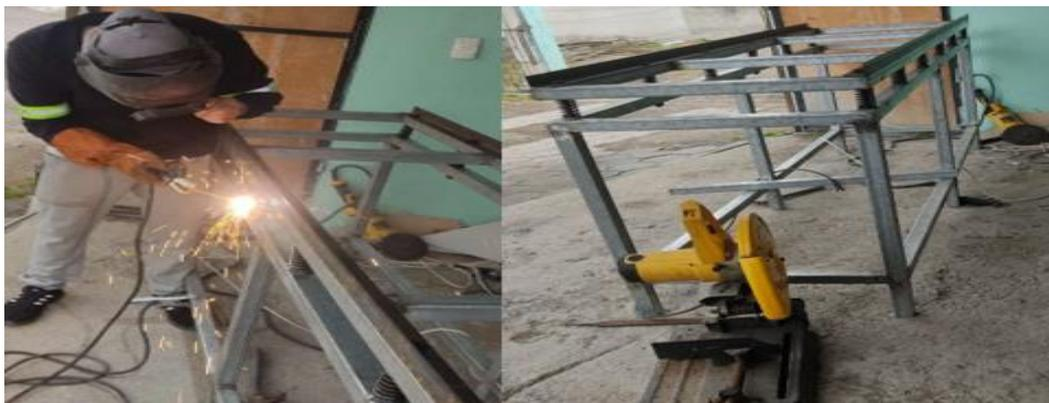
*Nota.* Se muestra el proceso de soldado y armado de las dos estructuras de la máquina.
