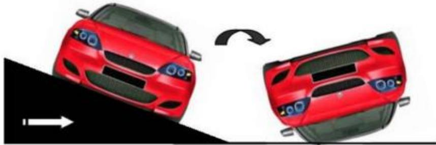
*Nota.* Se mira en la figura 7 una representación de la prueba de vuelco dinámica. Tomado de (Alberto, 2015).
