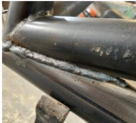
*Nota.* Se tiene la unión soldada limpia y corregida para que se pueda realizar la nueva prueba con las tintas penetrantes.
