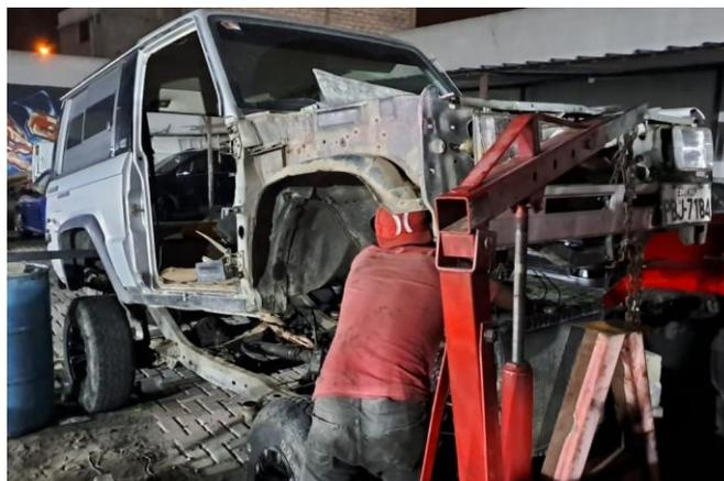
*Nota.* Se observa la separación del bastidor y la carrocería del vehículo trooper 4WD.
