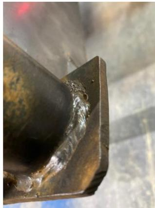
*Nota.* Se tiene la suelda limpia y corregida para realizar nuevamente el ensayo por tintas penetrantes.
