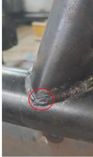
*Nota.* Fisura en la estructura a causa de la suelda
