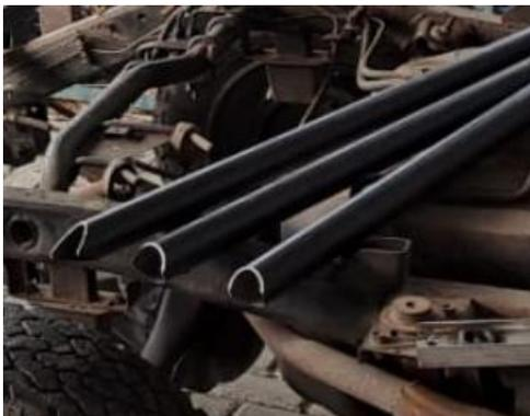
*Nota.* Se observa el corte en perfil del tubo para que se pueda ensamblar con otro, este corte se denomina boca de pescado.
