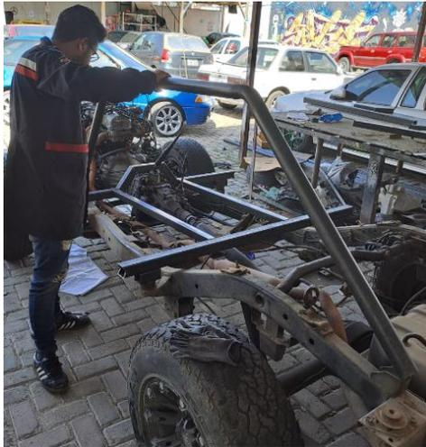
*Nota.* En la figura se aprecia el tubo ya doblado acorde al perfil de la figura 15.
