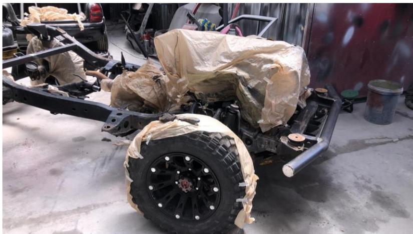
*Nota.* Se realiza el enmascarado de las partes que no se van a pintar del chasis del vehículo militar para aplicar la pintura en el bastidor.
