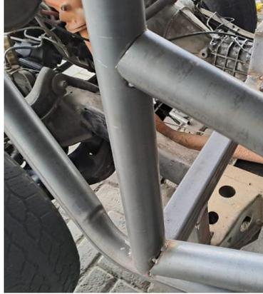
*Nota.* Se visualiza el punteado de soldadura para evitar deformaciones.
