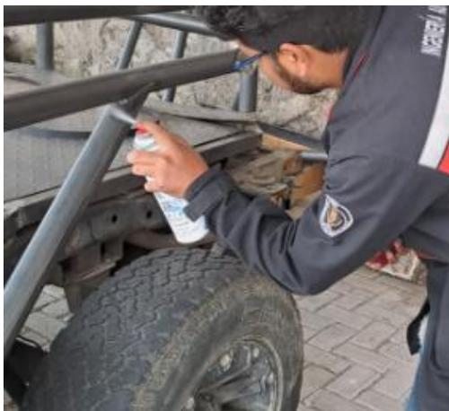
*Nota.* Se aplica el WEICON Detector de Grietas – Limpiador en la junta de soldadura.
