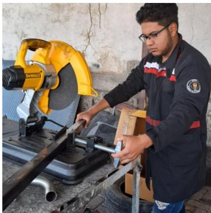
*Nota.* Se observa el posicionamiento del material previo a ser cortado.
