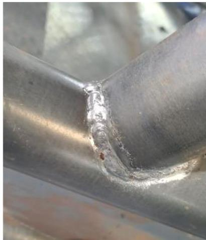
*Nota.* Se observa el cordón de soldadura realizado en la estructura.
