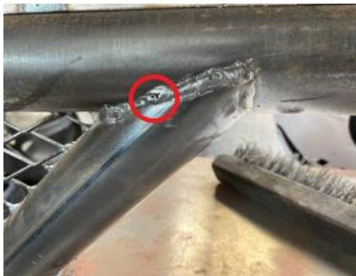
*Nota.* Poro en la estructura a causa de la suelda
