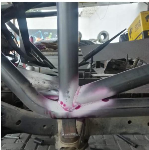
*Nota.* Se observa la prueba realizada en la unión la cual presenta defectos.
