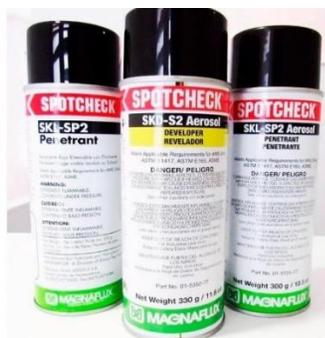
*Nota.* El kit de líquidos penetrantes consiste en 3 aerosoles los cuales son: Limpiador, Penetrante y revelador. Tomado de (Ferretería Industrial JB, s.f.)
