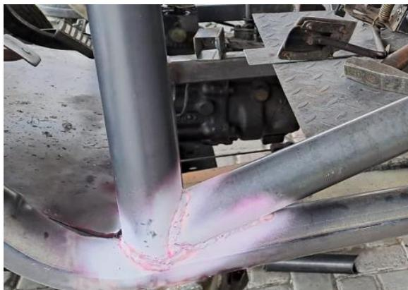
*Nota.* Se observa la prueba realizada a la unión soldada la cual fue reparada por presencia de defectos.
