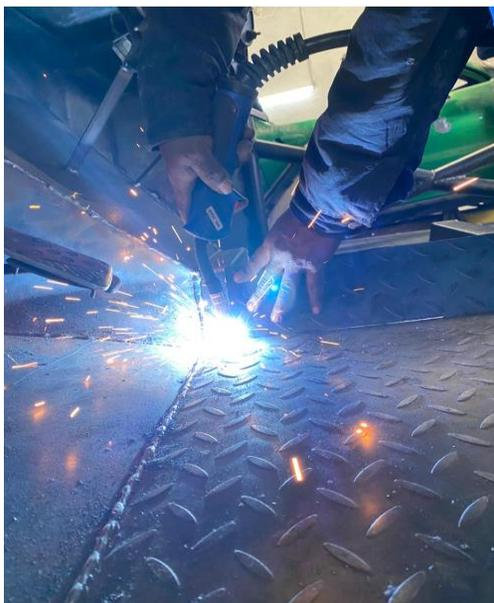
*Nota.* Después de la técnica de punteado para fijar las diferentes partes del piso, se procede a dar el cordón de soldadura final para unir por completo cada parte que conforma el piso.
