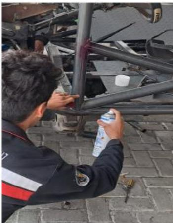
*Nota.* Se emplea el WEICON Detector de Grietas – Penetrante a una distancia aceptable.
