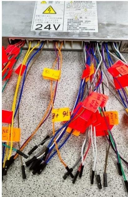
Se procede con la polarización de la ECU para la generación del pulso en los inyectores, se alimenta la ECU con 24V y las señales de los sensores CKP y CMP.
