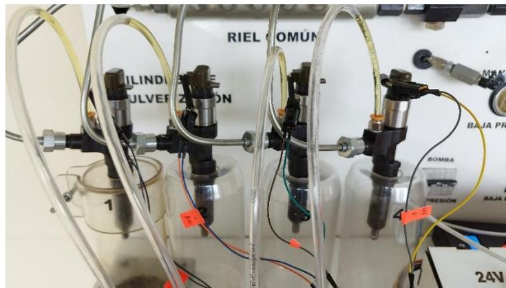
*Nota.* La figura muestra los cilindros de pulverización implementados en el módulo de pruebas junto con los inyectores y sus respectivas conexiones eléctricas e hidráulicas.
