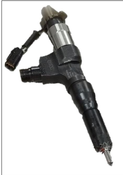
*Nota.* En la figura se muestra el Inyector solenoide Denso 6593 implementado en el módulo de pruebas CRDI.
