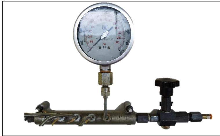
*Nota.* En la figura se muestra el acumulador de presión implementado en el módulo junto con el manómetro de alta presión y válvula manual para regulación de presión.
