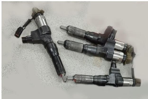
*Nota.* En la figura se muestra los 4 inyectores Denso 6593 usados por la marca Hino en su sistema CRDI.
