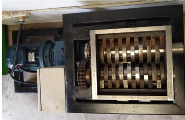
En este sistema el neumático es atrapado y dirigido hacia la trituradora por las cuchillas que se encuentran ubicadas en cada eje y giran en sentidos opuestos. Una vez atrapado el neumático, pasa por las cuchillas rápidamente y se produce el corte.
