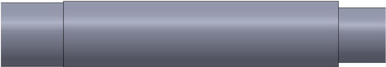
*Nota.* En la figura se muestra el resultado final de torneado en los dos extremos.
