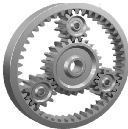
*Nota.* En la figura se muestra el sistema de engranaje planetario. Tomado de TurboSquid (2013).
