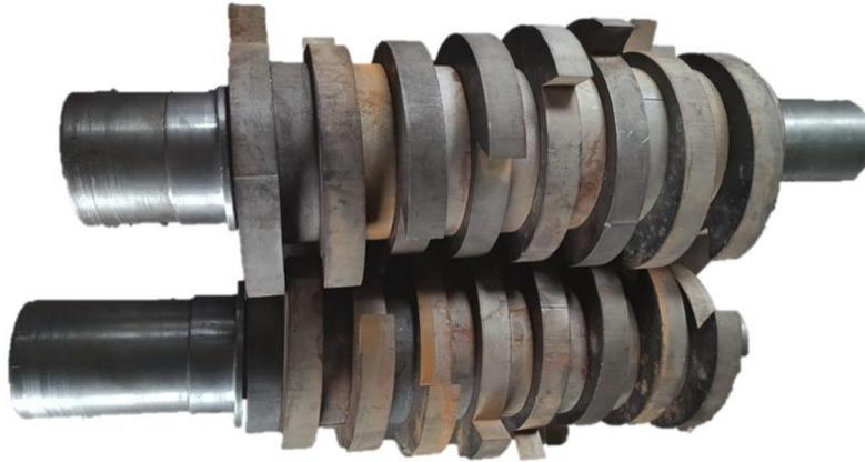
*Nota.* En la figura se muestra colocado tanto las cuchillas como los separadores de la trituradora.
