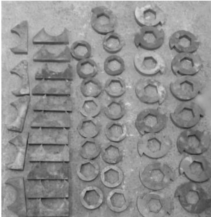
*Nota.* En la figura se muestran las piezas que se mecanizan mediante el corte, entre ellos se puede observar los separadores, bancadas y cuchillas.
