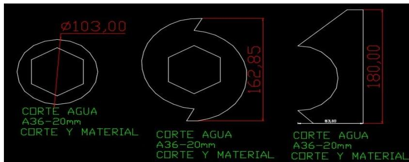
*Nota.* En la figura se detalla las dimensiones y el material que se va a utilizar para el corte por agua.
