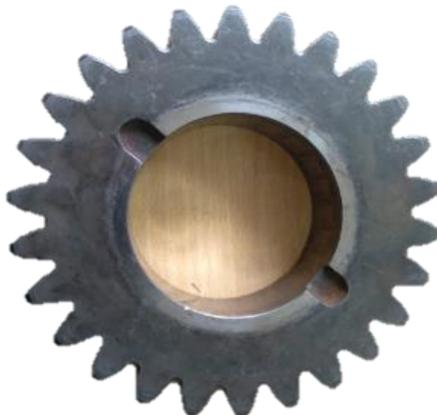
*Nota.* En la figura se muestra el engranaje que se usa para la construcción de la trituradora de neumáticos.
