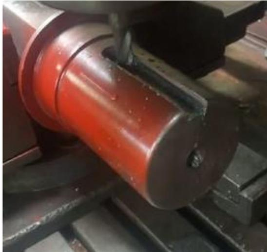
**Nota.** En la figura se muestra el chavetero que servirá para fijar los engranajes y la catalina de los ejes.
