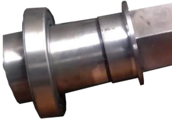
*Nota.* En la figura se muestra la ubicación de los rodamientos en la flecha.
