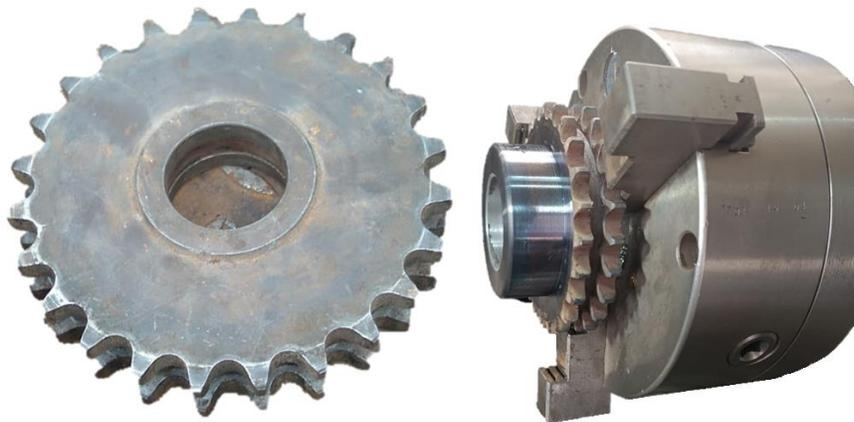
*Nota.* en la figura se muestra la catalina inicial y final para acoplarlo de manera que se pueda unir al eje del motor reductor y el eje motriz de la máquina trituradora.
