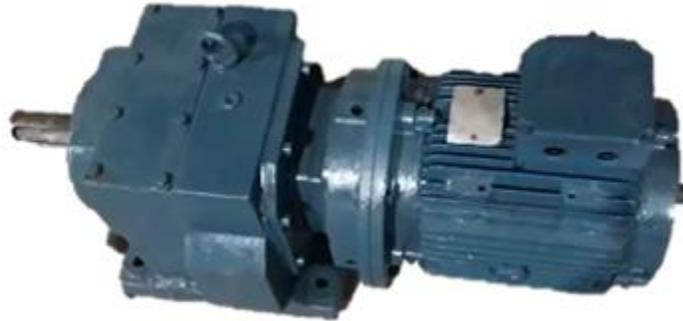
*Nota.* En la figura se muestra el motor reductor WEG de 7.5 HP.
