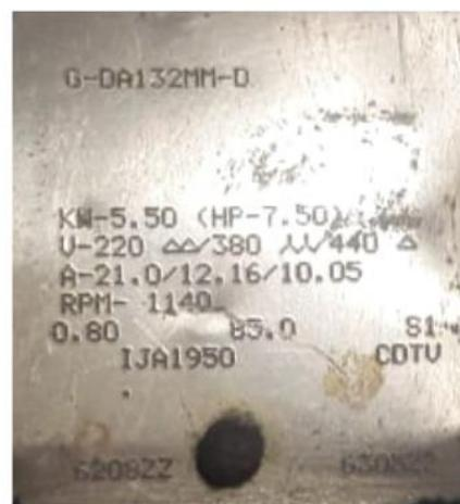
*Nota.* En la figura se muestra el motor reductor y la placa de datos que especifica las características.
