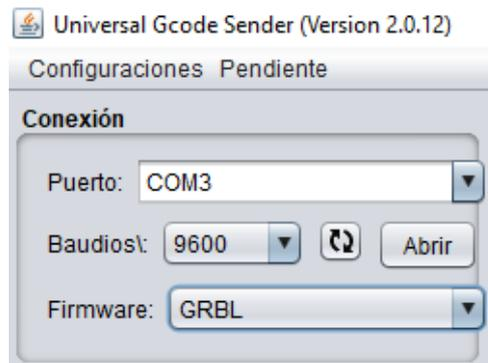
Nota. En la figura 58 se muestra los parámetros de conexión de Universal G Code Sender.
