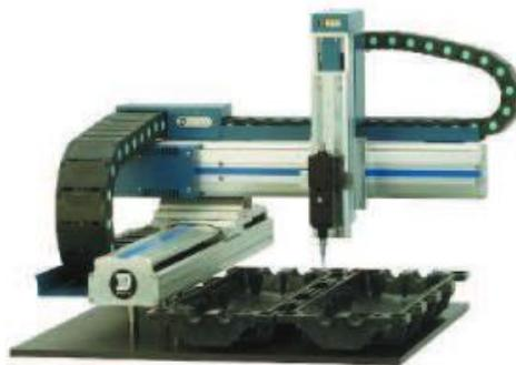
*Nota.* En la figura 2 se muestra un modelo de fresadora CNC con brazo cantiliver.
