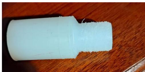
*Nota.* Se aprecia un resultado áspero, pero con una precisión mejorable que permite el mecanizado de este tipo de materiales.
