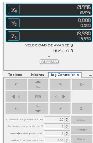
*Nota.* En la figura 49 se muestra los controles de avance para ejecutar los movimientos de los ejes para el módulo de torneado.
