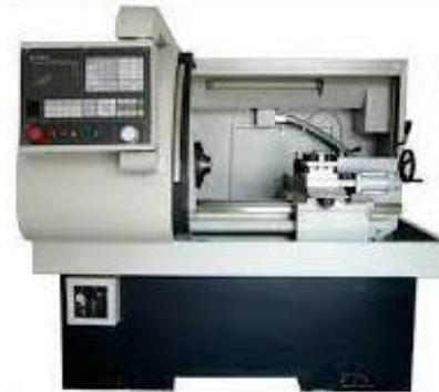
*Nota.* En la figura 5 se muestra un modelo de torno CNC paralelo de 2 ejes.
