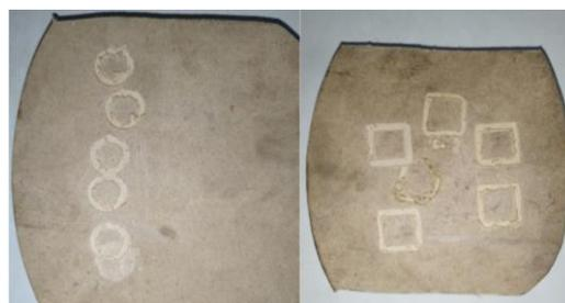
*Nota.* En la figura 88 se muestra las pruebas realizadas en mecanizado de figuras cuadradas y circulares sobre madera suave.
