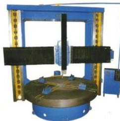
*Nota.* En la figura 6 se muestra un modelo de torno vertical CNC de 2 ejes.
