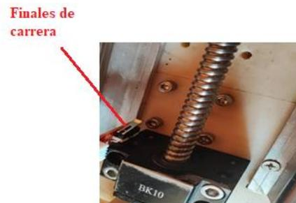
*Nota.* En la figura 70 se muestra la instalación de los switches limitadores de carrera.
