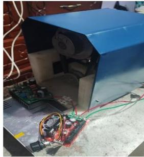
*Nota.* En la figura 49 se muestra la prueba de encendido del husillo del torno CNC.
