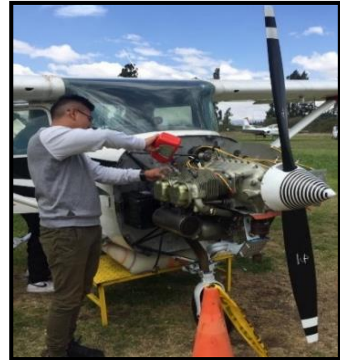
Colocación de lubricante
