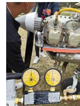
Medida del nivel de compresión del cilindro N°4
