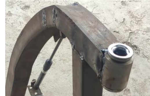
Colocación de bocines en los brazos
