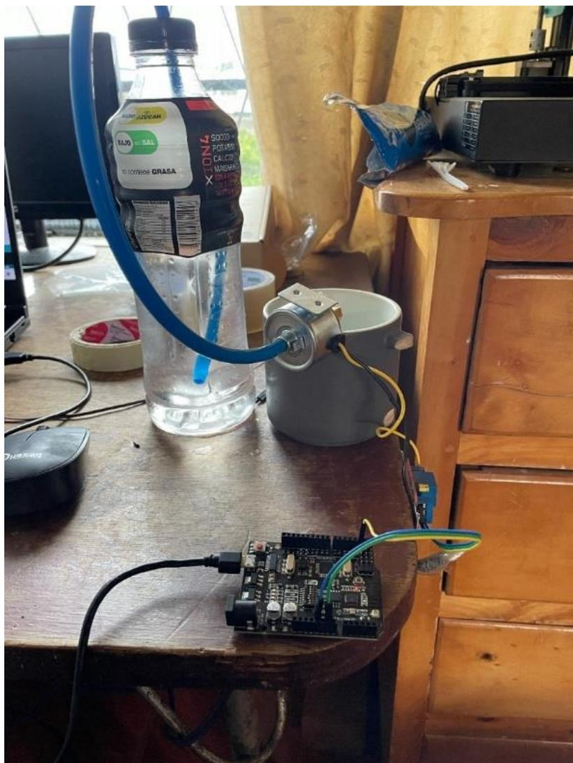
Fueron aplicadas 10 pruebas con diferentes tiempos para comprobar el volumen. (Figura 62). El proceso implicó utilizar un programa de pruebas en Arduino y medir el resultado mediante un contenedor numerado.
