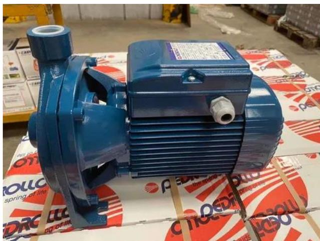
La bomba seleccionada fue de 220 voltios y 6 amperios. Para su alimentación se consideró un arrancador que permite ahorrar espacio y conexiones, y únicamente fue deshabilitado el pulsador. Se cableó a la etapa de control gobernada por el PLC mediante un relé como lo muestra la Figura 49.
