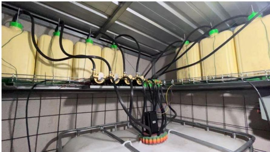
A continuación, la Figura 52 muestra el montaje de las mangueras y del motor mezclador. Para este paso se requirió imprimir en 3D con la finalidad de realizar el ensamblaje de una manera más ordenada.
