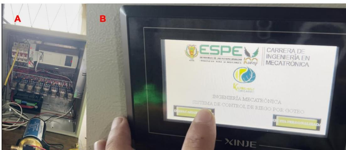
El lado A expone cómo se realizaron las pruebas con el tablero energizado, pero sin conectar los elementos (bombas y motores). En cambio, el lado B evidencia la manipulación del HMI.
