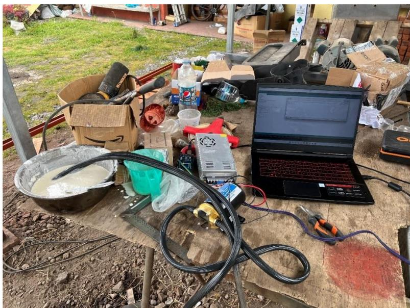
Se ejecutaron 10 pruebas con diferentes tiempos para comprobar el volumen que ofrece la bomba de engranajes. La Figura 59 expone la manera en que las pruebas fueron llevadas a cabo; el proceso implicó utilizar un programa de pruebas en Arduino y medir el resultado mediante un contenedor numerado con el volumen, una vez finalizadas la pruebas mediante la placa Arduino y calculado la razón de transformación se implementó en el programa del PLC.
