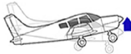
**Eje Transversal o Lateral:** Eje imaginario que va desde el extremo de un ala al extremo de la otra. El movimiento alrededor de este eje (morro arriba o morro abajo) se denomina cabeceo ("pitch" en inglés).
