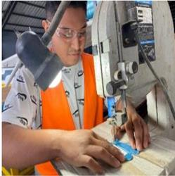
Con ayuda de una sierra eléctrica separamos los Hinge Brackets y le designamos el nombre de acuerdo al manual de ensamblaje
