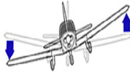
**Eje Longitudinal** Es el eje imaginario que va desde el morro hasta la cola del avión. El movimiento alrededor de este eje (levantar un Ala bajando la otra) se denomina alabeo (en inglés "roll")
