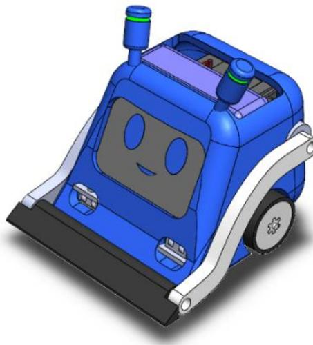
En el primer prototipo se diseñó con el fin de que la nueva pantalla quede de la manera adecuada y creando protecciones para la pantalla en caso de cualquier golpe de frente, así como se colocó tanto soportes para la batería en la parte de atrás y para los tornillos de la placa para la pantalla y el diseño para que el pulsador sea parte de la estructura como se muestra en la Figura 23, el cual se descarta por ser muy frágil en la parte superior.
