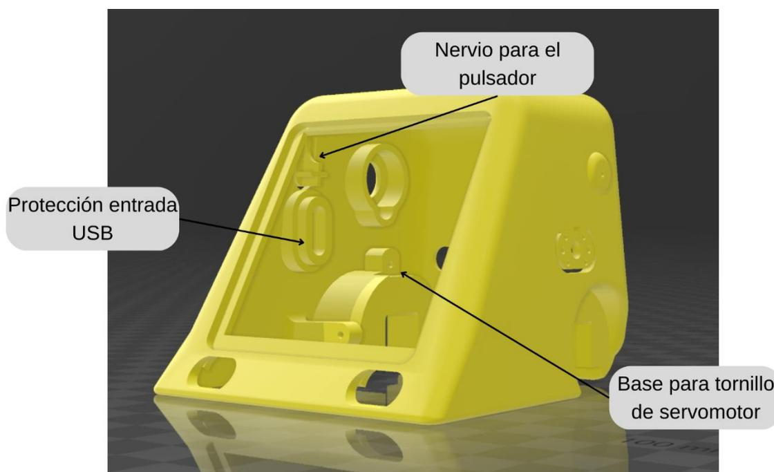
Después de realizar el análisis de los anteriores prototipos se determinan los cambios más relevantes que permiten que los elementos se mantengan en su lugar y ocupen menos espacio para el cableado y los elementos extras que se requieran colocar, primero se tuvo que cambiar los sensores por lo cual la forma debe variar y solo se conservan los delanteros como se muestra en la Figura 27 y en la parte trasera se coloca un switch.
