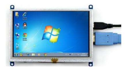
Nota. Pantalla Waveshare compatible con todos los modelos de Raspberry Pi 4. Tomado de (Waveshare , 2022)
