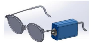
Nota. Diseño del soporte para la cámara. Tomado del Autor
