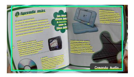
Realizadas diferentes pruebas se determina que el detector, presenta una eficiencia del 100 % en la detección del texto, debido a diferentes tamaños de fuentes facilita la detección, se puede visualizar que si una imagen presenta texto el detector es capaz de reconocer de una manera eficiente, se puede detectar diferentes tipos de letras de una manera óptima y priorizar la lectura de izquierda a derecha.
