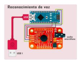
Nota. Conexión del módulo para reconocimiento de voz mediante arduino. Tomado de Autor
