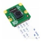
Nota. Módulo de cámara de Raspberry Pi 4. Tomado de (The Pi Hut, 2022)
