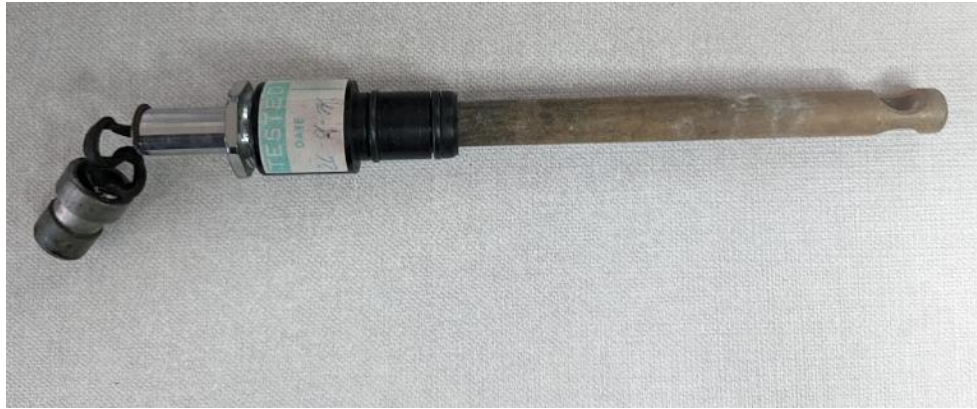
Termistor original del equipo
