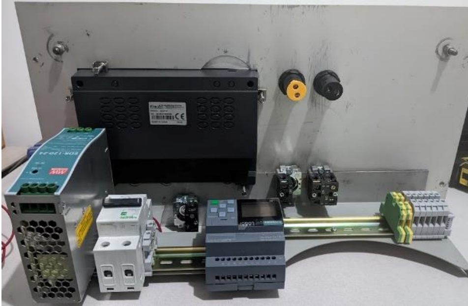
Implementación de los componentes en el riel DIN
