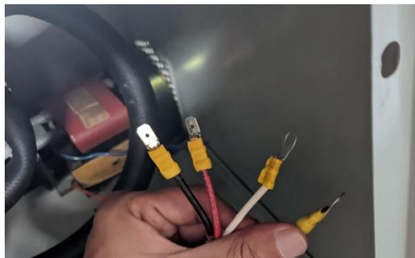
Realizado esto se completó el cableado a todas la borneras correspondientes a cada uno de los elementos previamente vistos (figura 66), con esto se consigue que el sistema eléctrico sea modular y no requiera un desarmado completo para el reemplazo de cualquier componente cuando esto sea necesario.
