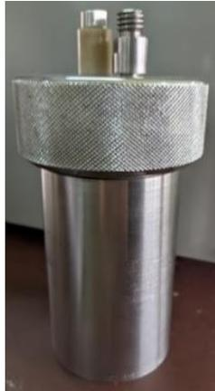
Una de las pruebas realizadas fue la de presión y prueba de fugas en la bomba calorimétrica como se muestra en la figura 20, trabajando con presiones de 20 – 30 bar, (290 - 435 psi) ya que es el rango de presión en el cual se van a realizar los ensayos.
