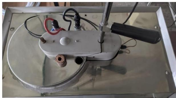
En el interior del equipo podemos observar y analizar como primer punto el estado del tanque de la camisa de agua mostrado en la figura 17, el cual evidencia mantenimientos
