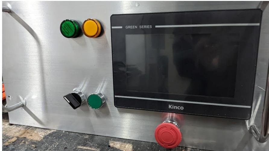
Como se puede observar se reemplazaron todos los controles que existían en el panel frontal del equipo, por elementos nuevos y sobre todo se eliminaron varios de ellos puesto que se incorporaron dentro de la interfaz hombre máquina. Adicionalmente se incorporó un paro de emergencia ya que el equipo no lo poseía previamente, (véase la figura 56). Este es un elemento de seguridad esencial en todos los equipos por lo cual se ha decidido colocarlo dentro del rediseño del panel.
