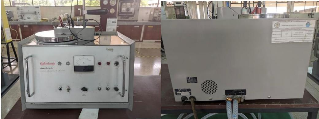
En cuanto respecta al estado general mecánico interno del equipo, se puede observar en la figura 4 que el tanque de la chaqueta de agua presenta un mantenimiento realizado previamente para corregir fugas que se han presentado previamente. Así como también se encuentran las mangueras de circulación de la chaqueta de agua en mal estado.
