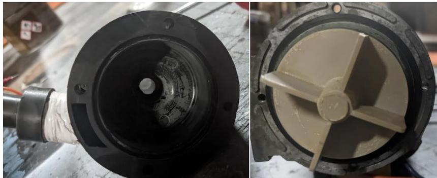
Además de esto se recubrió a la tapa plástica con silicona UV para recuperar sus propiedades y darle una mejor apariencia. Adicionalmente se cambió el teflón del acople para evitar fugas en el futuro, figura 41.
