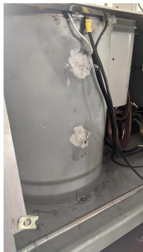
Analizando de manera general el componente eléctrico del equipo se puede observar que presenta varias deficiencias, como lo son: cables desconectados de varios de los componentes, empalmes técnicamente mal realizados, aislamiento de terminales nulo
