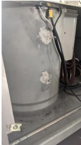
Al interior del equipo se puede observar las mangueras pertenecientes al circuito de circulación de la camisa de agua. El equipo posee un total de seis mangueras, tres pertenecientes al circuito de circulación de la camisa de agua y las otras tres a la alimentación y desfogue de agua de la camisa.
