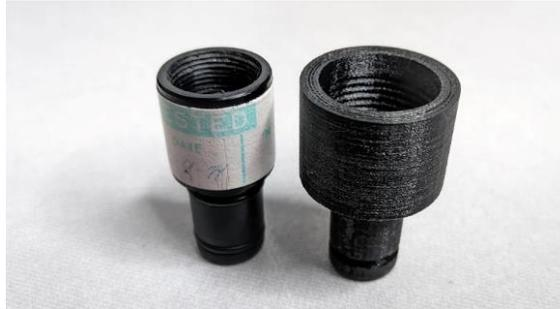
Finalmente se colocó los acoples a los sensores de temperatura HDT500 y al conjunto se lo fijó en las cavidades respectivas sobre la tapa de la camisa de agua obteniéndose el resultado de la figura 74.
