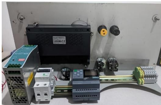
Realizada la colocación de los componentes se procedió a añadir borneras y a cablear los componentes para realizar primeras pruebas en las cuales se evaluaría el funcionamiento de los componentes, figura 62.
