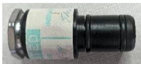
Se tomaron las medidas necesarias tanto de los nuevos sensores como de la cavidad en la cual deben ingresar y mantenerse fijos por la presión de los o-ring para proceder a diseñarlo como se puede ver en la figura 71.
