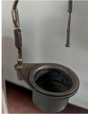
Los elementos de la bomba calorimétrica, figura 21, y del sistema térmico en general se encuentran en buen estado, transfieren la temperatura correctamente hacia el ambiente en el que se encuentran, y en el crisol no se evidenciaron fugas al utilizar una muestra líquida.
