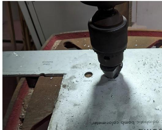
Se realizaron perforaciones tomando las medidas de los elementos adquiridos, tanto para las luces piloto como para el pulsador y el selector para de esta manera obtener el diámetro adecuado para poder colocarlos.
