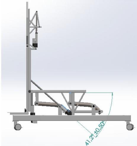
Acero AISI 1020 estirado en frio con un módulo de resistencia de  $S_y = 441 \text{ MPa}$ .
