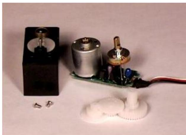
*Nota.* En la figura se aprecia los elementos que constituyen un servomotor, tales como lo son los engranes de reducción.
