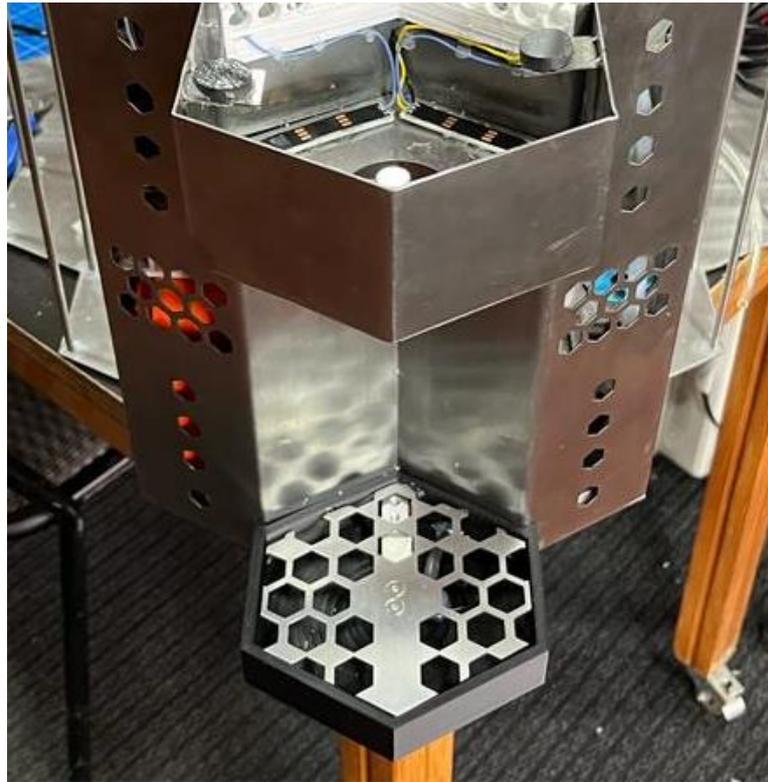
A continuación, se procede a introducir el tablero de distribución dentro del módulo frontal, distribuyendo las mangueras tanto para la parte posterior donde se anexarán a las botellas, como para la parte frontal para suministrar el líquido extraído en el vaso.
