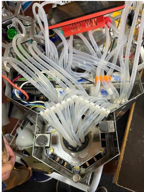
Finalmente, el módulo frontal se cubre con la tapa superior, y sobre la cual se anexa la raspberry pi con la pantalla touchscreen.
