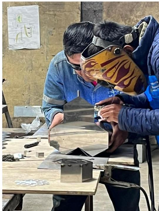
Cabe destacar que todo este proceso de soldadura se realizó mediante soldadura TIG, debido a que es adecuada para soldar aceros de alta calidad y de alta resistencia, permitiendo una mayor precisión y control en la soldadura.
