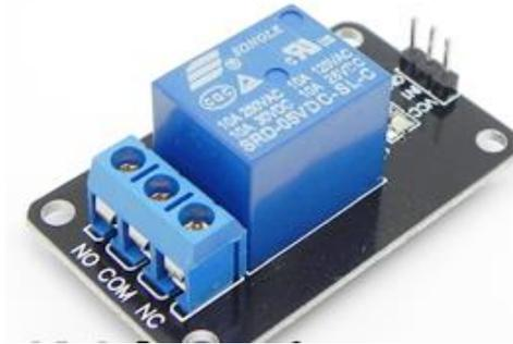
*Nota.* La figura muestra el módulo relé de Arduino. Tomado de UAEH Módulo relé por (García, 2021)
