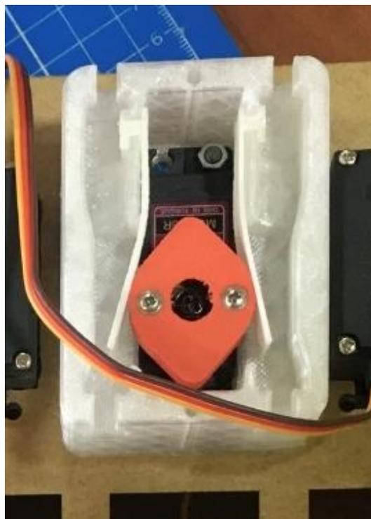
Así pues, se realizaron pruebas instaladas las válvulas en una base de madera, comprobándose que en efecto detenían el flujo del líquido y el aire, pero las lenguas tras varios ciclos de uso tendían a romperse, dejando el mecanismo inhabilitado, pues empezaría a rosar la silicona del tubo directamente con la leva.
