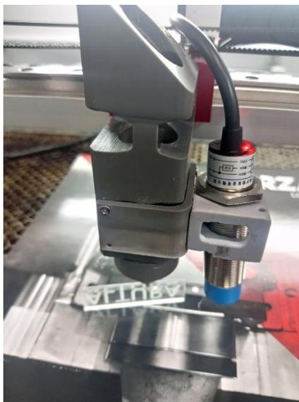
A continuación, se va a detallar en la siguiente Tabla 8 los materiales y distancias detectadas tanto de forma manual como automática por el sensor capacitivo
