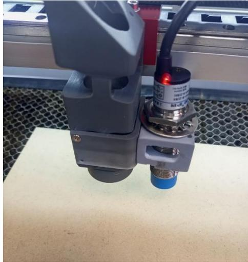
De igual manera se procedió con el material denominado acrílico el cual se procedió con colocar la cama en una distancia prudente Figura 46, acercando la cama hasta la distancia correcta tanto de forma manual como en la Figura 47, de forma automática con el sensor como en la Figura 48.
