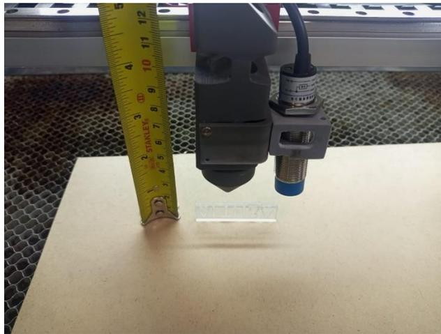
Se observa en la Figura 42 que tanto la altura de 12 mm y el sensor no están en la distancia correcta antes de que empiece a cortar por lo tanto primero se procedió subir la cama de forma manual, para observar la posición correcta que necesita antes del proceso de corte como se observa en la Figura 43.
