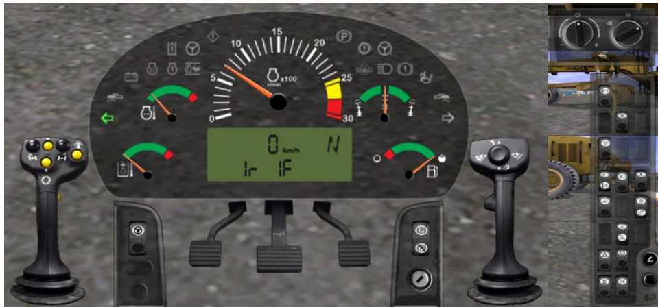
Sistema de monitoreo virtual de la máquina CAT 140M
