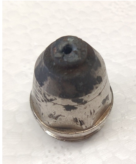
Deficiente control de altura
