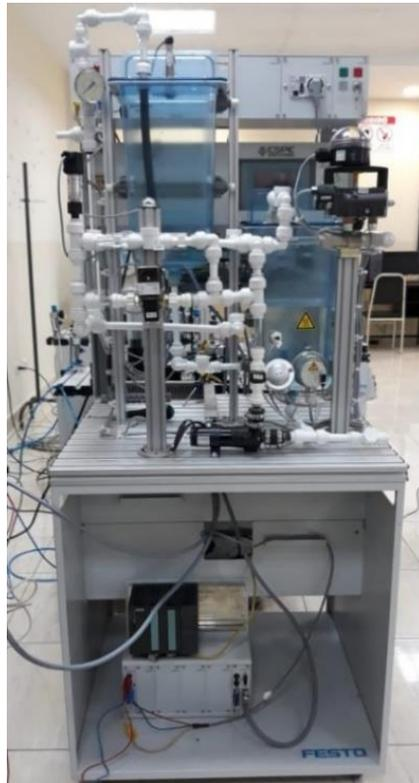
La estación de trabajo MPS compacta, se compone de cuatro lazos cerrados, que está constituido de sensores y actuadores tanto analógicos, así como digitales, igualmente dispone de un PLC o un controlador el cual se puede controlar de manera individual o en grupo (Reyes & Navaez, 2013,p. 25), teniendo los siguientes controles:
