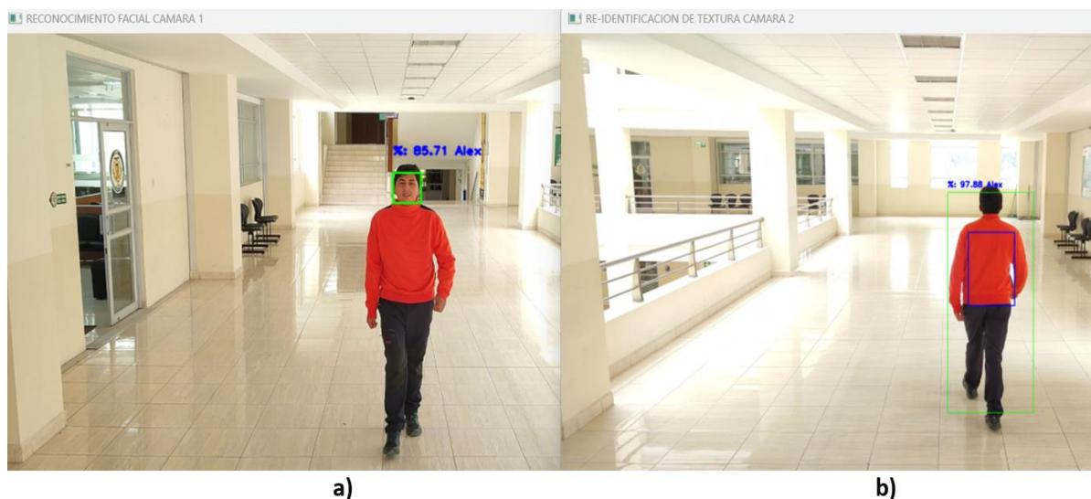
*Nota.* Salida de videos del sistema de Re-Identificación de la clase: Alex: a) Salida de la cámara 1: detección e identificación de la clase Alex mediante el reconocimiento del rostro y en b) Salida de la cámara 2: detecta y Re-Identifica a la clase Alex, a través de la textura de la vestimenta del torso.
