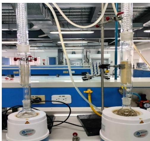
*Nota.* Extracción del genipín por medio del equipo Soxhlet.
