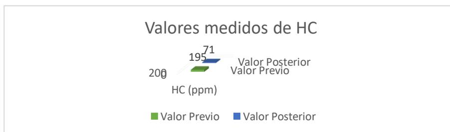
*Nota.* El gráfico muestra un análisis gráfico comparativo de las emisiones de HC del motor, antes y después de su reparación.
