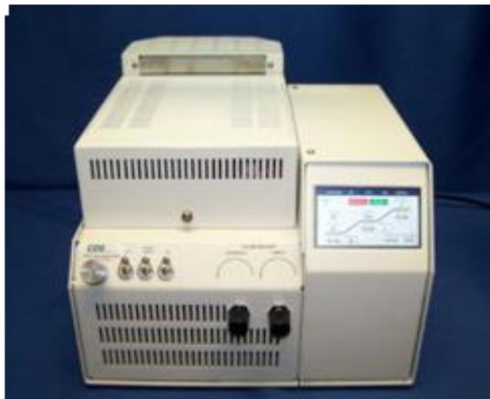
*Nota.* El gráfico muestra un analizador de gases de combustión para motores a gasolina, permanente. Tomado de (Ingeniería Analítica, 2015).
