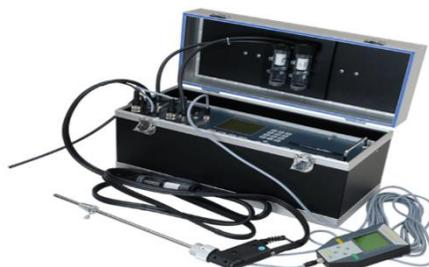
*Nota.* El gráfico muestra un analizador de gases de combustión para motores a gasolina, electroquímico. Tomado de (Premac Energy, 2020).
