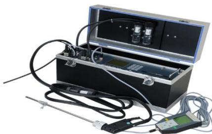
*Nota.* El gráfico muestra un analizador de gases de combustión para motores a gasolina, multisensor. Tomado de: (Direct Industry, 2023).
