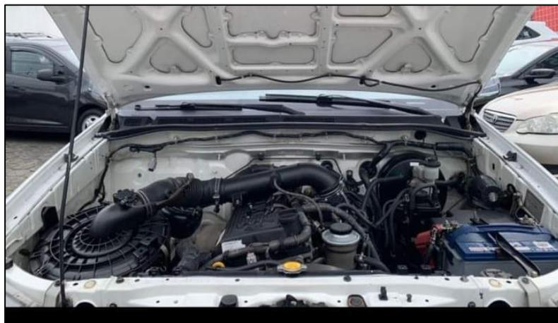
*Nota.* El gráfico muestra el motor Toyota 2TR ya reparado y montado en la carrocería de la camioneta correspondiente.
