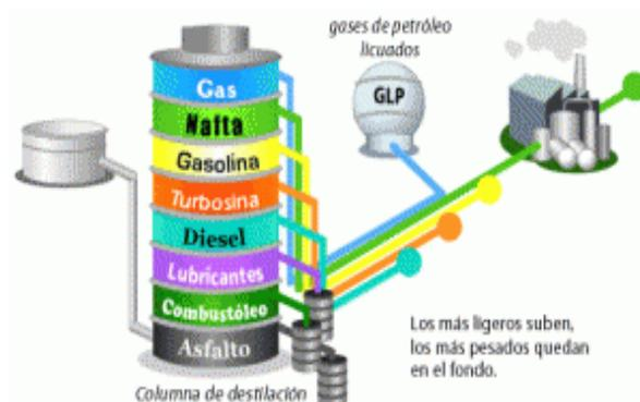
*Nota. El gráfico representa un esquema del proceso de obtención de la gasolina. Tomado de (Tema 2: Combustibles fósiles e hidrógeno 2.1 Carbón 2.1.1 Procesos de formación 2.1.2 Tipos, estructura y composición 2.1.3 Usos 2.2 Petróleo 2.2.1 Formación y extracción 2.2.2 Procesamiento de gasolinas 2.1.3 Gas natural 2.3 Aplicaciones del hidrógeno en la producción de energía. 2.4 Celdas Combustibles, s. f.)*
