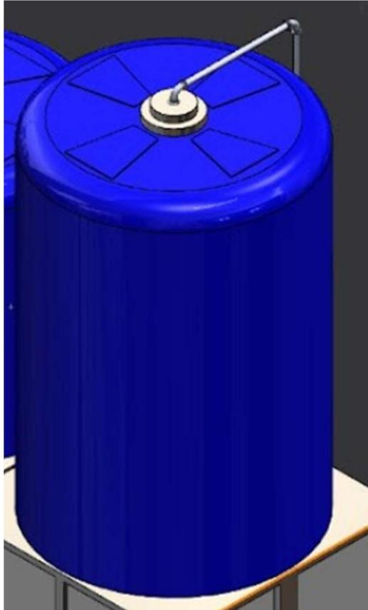
*Nota.* Tanque de agua tratada de 4.80 metros de alto realizado en Autocad 3D.
