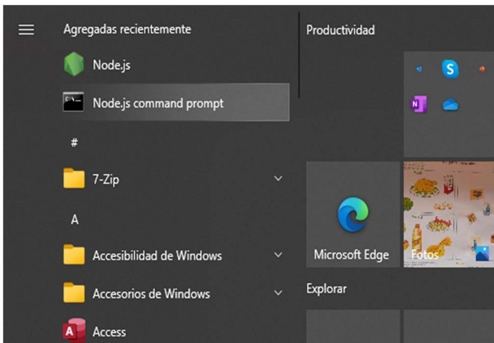
11. Abrimos la línea de comandos de Node.js (“Node.js command prompt”) y ejecutamos el comando “npm install -g node-red” para instalar Node-RED globalmente en nuestro sistema, como se muestra en la Figura 71.
