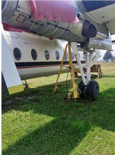
*Nota.* la imagen muestra el tren de aterrizaje principal de la aeronave y la gata hidráulica que lo sostiene.
