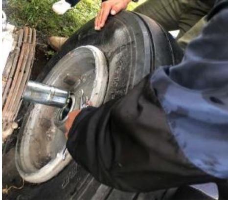
*Nota.* instalación del neumático del tren de aterrizaje principal.
