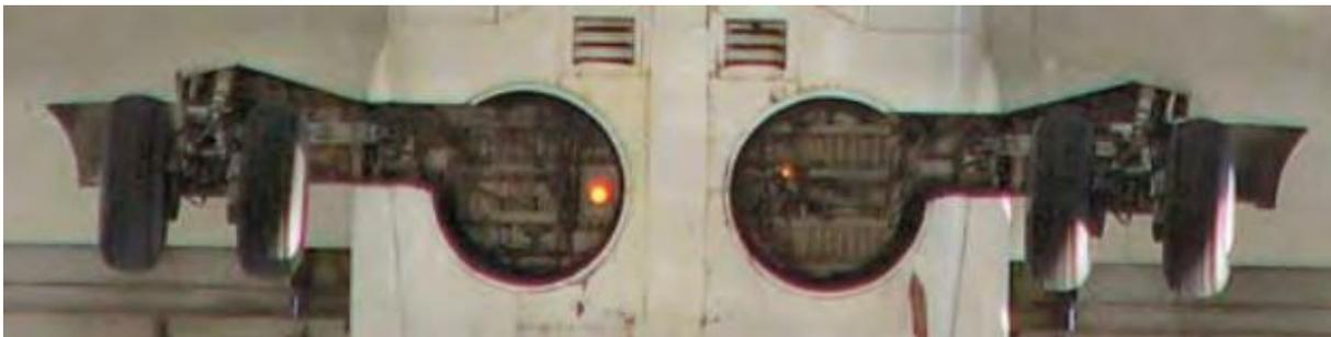
*Nota.* Los conjuntos de ruedas se acoplan con sellos para proporcionar un flujo aerodinámico sin puertas. Tomado de (FEDERAL AVIATION ADMINISTRATION. 2018).
