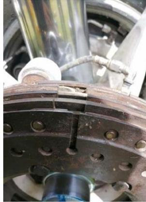
*Nota.* Alineación de los orificios del disco de freno.
