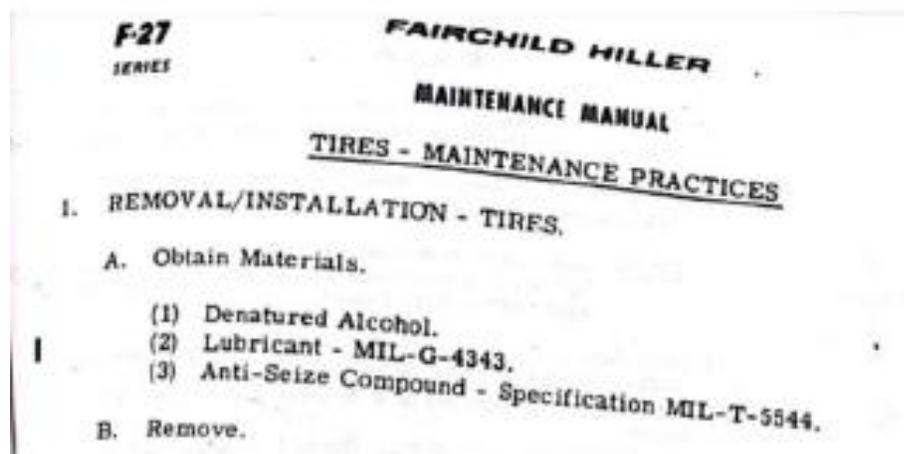
*Nota.* en el literal A muestra los 3 materiales que vamos a necesitar que es el alcohol, lubricante y antiadherente.
