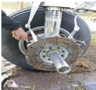
*Nota.* Vista del disco de freno, donde se puede observar que está desgastado, en el aterrizaje de la aeronave siempre se consumirá una parte del disco para poder reducir la velocidad de la aeronave.
