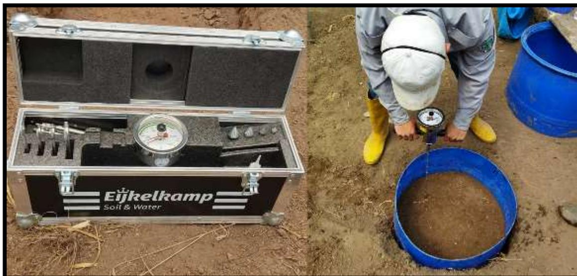
*Nota.* Instrumento utilizado para medir el nivel de compactación del suelo.
