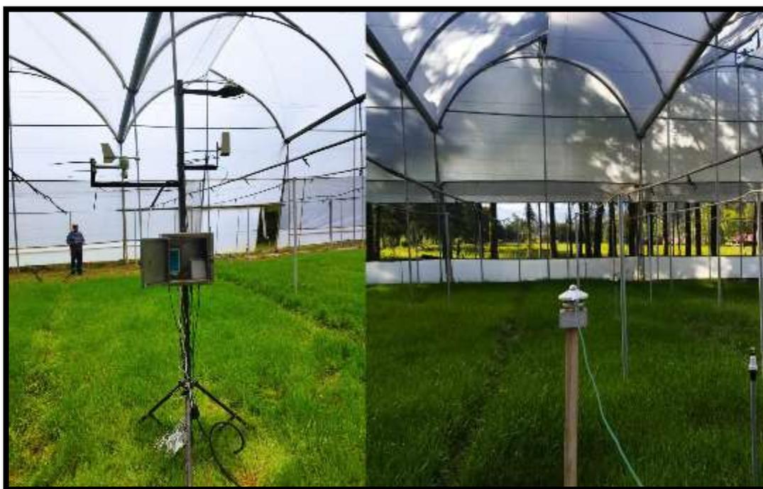
*Nota.* Estación agro meteorológica automática modelo WS-2317 Weather Pro Center a la izquierda, piranómetro CPM3 a la derecha
