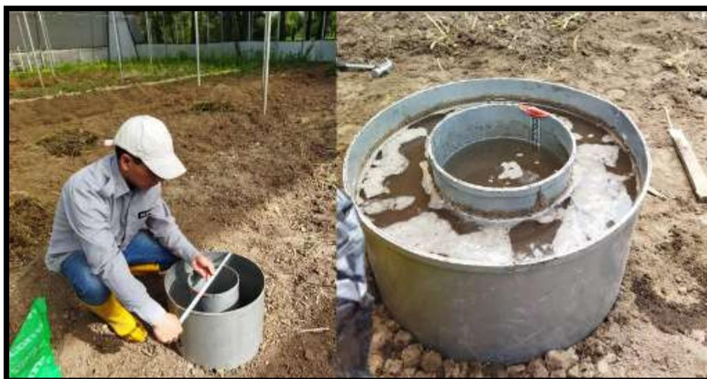
*Nota.* Instalación de cilindros infiltrómetros, estos fueron enterrados 10 cm y nivelados.
