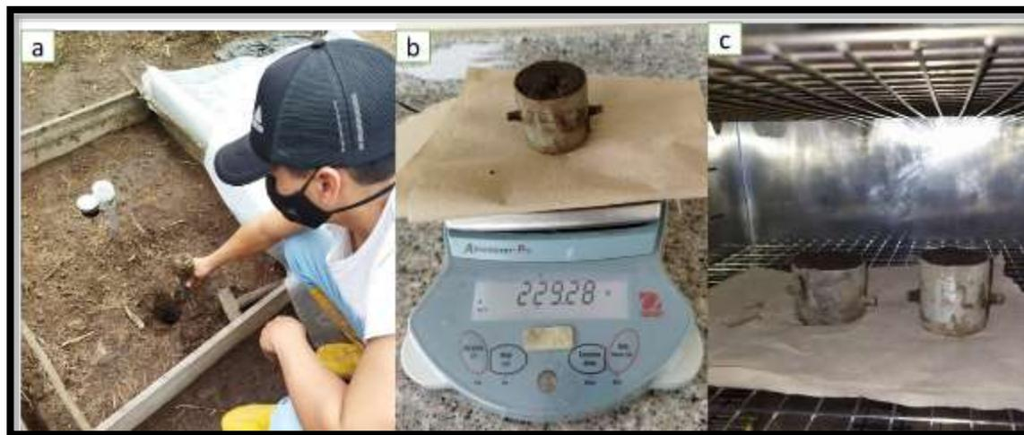
*Nota.* En la figura a) toma de muestra de suelo a determinada tensión, b) peso de la muestra en húmedo y c) secado de la muestra en estufa a 105°C durante 24 horas
