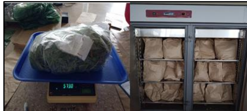
Pesaje y secado en estufa con aire forzado a 55 °C durante 48 h
