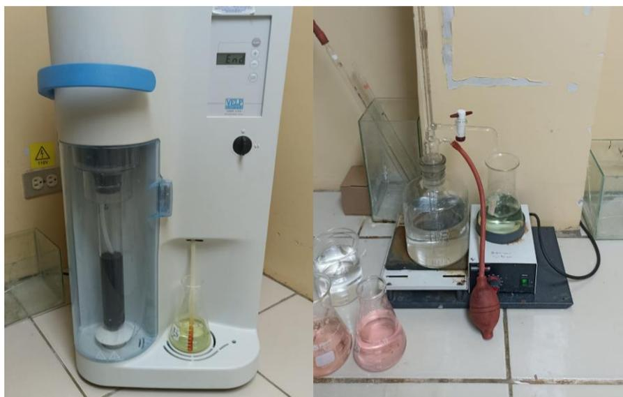
*Nota:* Equipos del método Kjeldahl
