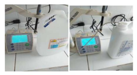
*Nota.* Medición de la conductividad eléctrica realizadas a las muestras de agua comercial. El valor de la conductividad eléctrica obtenida en el laboratorio fue de 1.73 ( $\mu S cm^{-1}$ ) para el agua de "La casa de los Químicos".
