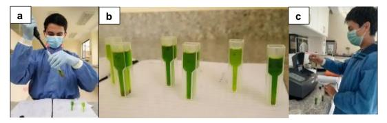
Nota. a) Extracción del macerado centrifugado; b) colocación en cubetas; c) Lectura de absorbancia en el espectrofotómetro
