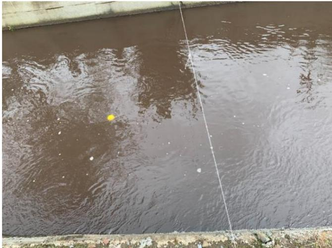
Método del Flotador
