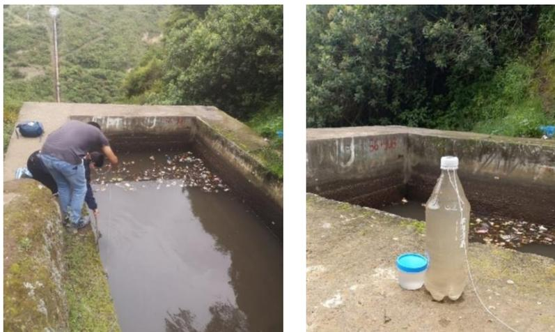
*Nota.* La figura muestra la toma de muestra del agua del sistema de riego El Pisque.
