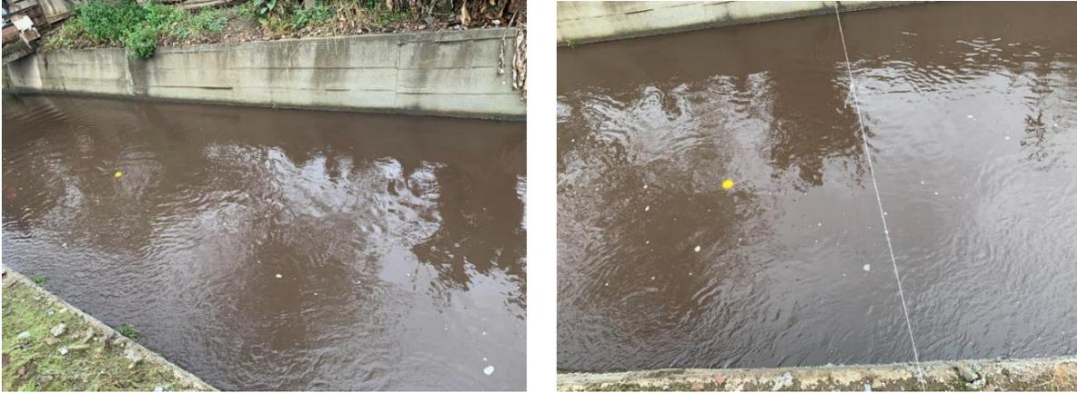
*Nota.* La figura muestra el flotador recorriendo el tramo analizado para la aplicación del Método del Flotador.
