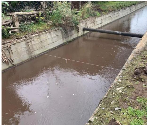
*Nota.* La figura muestra la marca del Final del Recorrido de 5,00 m para la aplicación del Método del Flotador.
