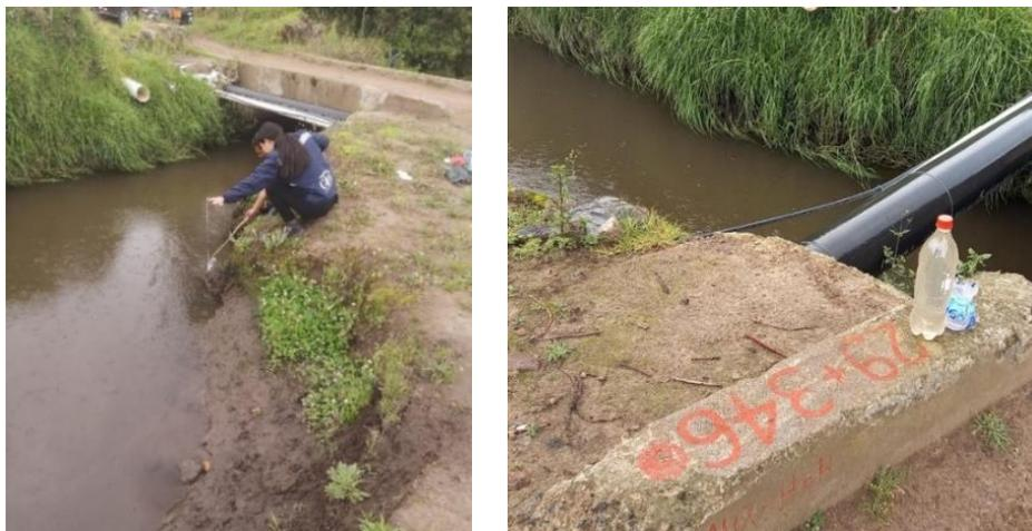
*Nota.* La figura muestra la toma de muestra del agua del sistema de riego El Pisque.
