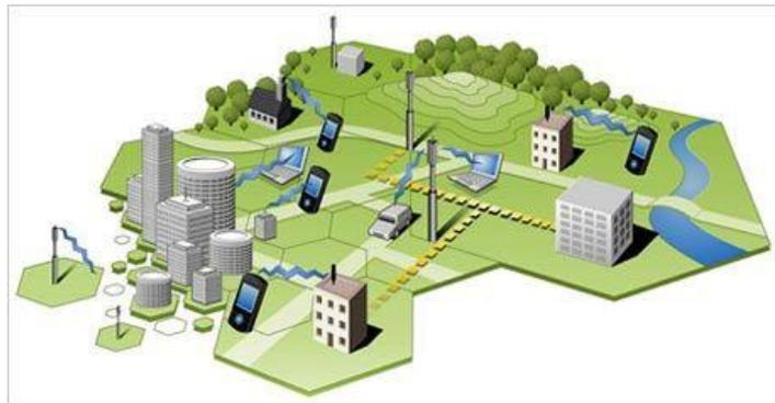
Nota. La figura se observa cómo trabaja la estación base al enviar y recibir señales de radio con baja potencia. Tomado de: (EMF Explained, 2013)
