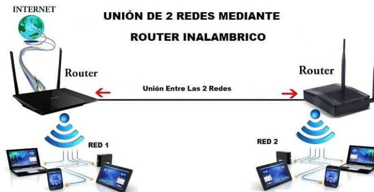
*Nota.* En la figura se observa la conexión de dos router que trabajan como un conmutador que recibe señal desde un punto hacia otro punto principal. Tomado de: (Redes Inalambricas, 2022).
