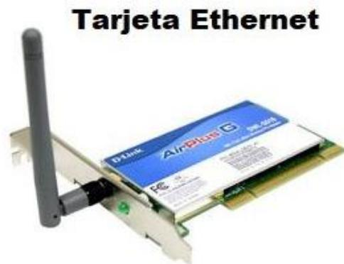
*Nota.* La figura indica un puerto de la tarjeta Ethernet que se conecta a una antena para el envío de la información. Tomado de: (Redes Inalámbricas, 2022)
