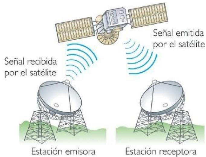
*Nota.* En la figura se observa la transmisión de señal que realiza el satélite en formas de ondas de radio de alta frecuencia. Tomado de: (ConceptoABC, 2022)
