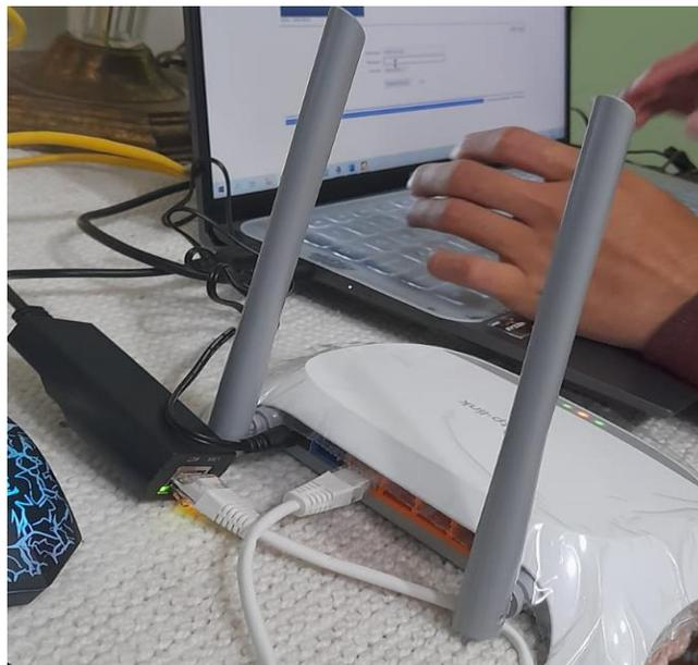
*Nota.* La figura, muestra el Router Inalámbrico TP WR840N el cual es usado como Access point y se conecta cable al adaptador de red de la computadora.
