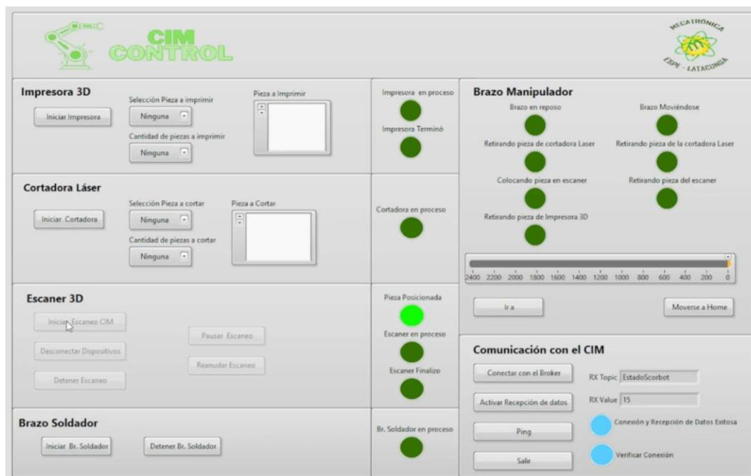
Con la pieza ya posicionada, la estación de escaneo 3D iniciará su proceso de escaneo 3D y el brazo estará en reposo hasta que le envíe otra orden de ejecución. Esto se visualiza en la figura 39
