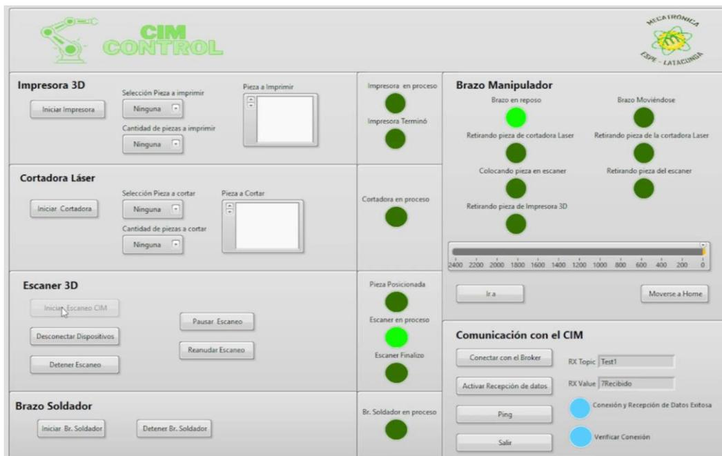
Una vez culminado el escaneo, la estación de escaneo 3D envía un dato indicando que terminó, por lo cual el brazo se acercará a la estación a retirar la pieza. En la figura 40 se indica el estado de la interfaz de control y monitoreo, por otro lado la figura 41 muestra al brazo robótico colocando la pieza en el almacén después de ser escaneada.
